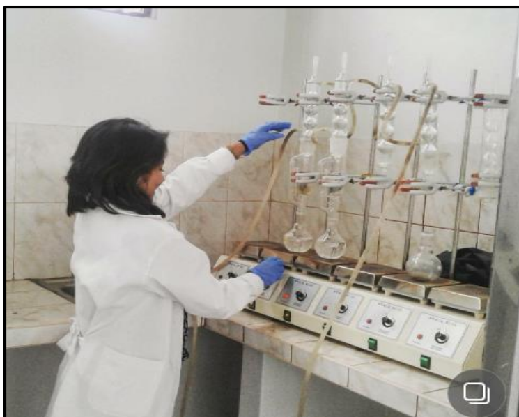
Figura 35. Evaluación del porcentaje de remoción de crudo de petróleo de cada unidad experimental mediante metodología Soxhlet. Fuente: Elaboración propia.
