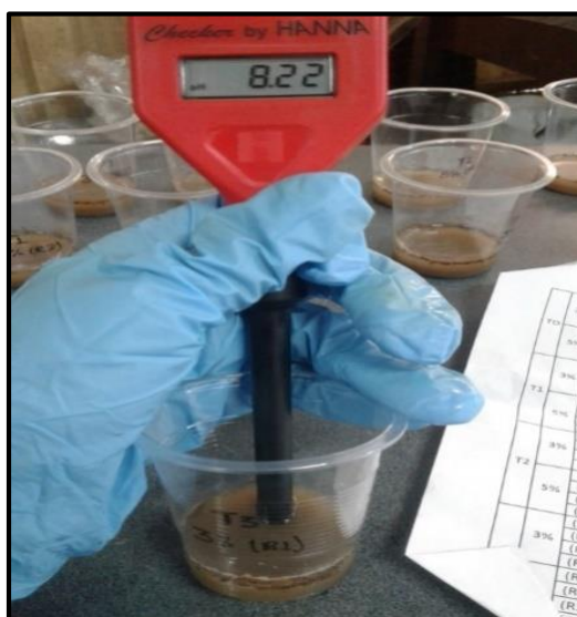
Figura 29. Medición de pH a cada una de las unidades experimentales. Fuente: Elaboración propia.
