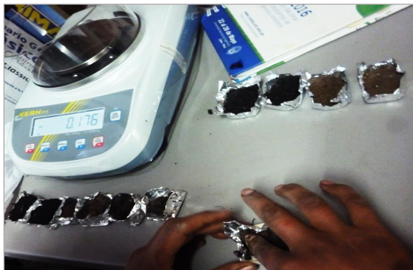
Figura 13. Medición del peso de las muestras de suelo. Fuente: Elaboración propia.
