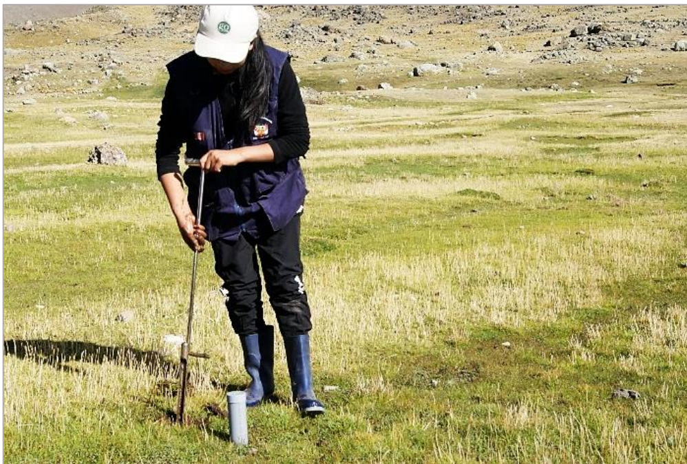
Figura 12. Extracción de muestras de suelo. Fuente: Elaboración propia.
