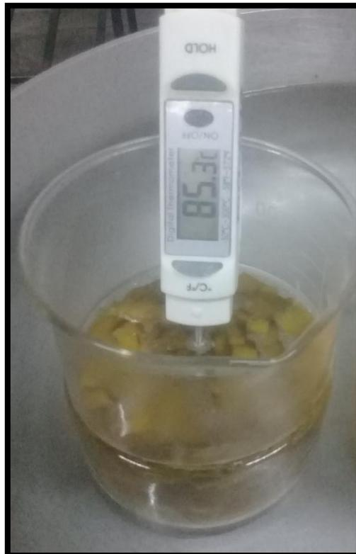
Estabilización de la temperatura en la etapa de hidrólisis ácida
