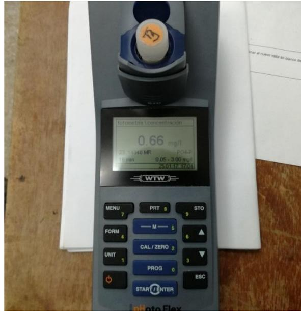
*Figura 12:* Cuantificación del fósforo total mediante técnicas espectrofotométricas. Instrumento multiparamétrico Photoflex WTW.
