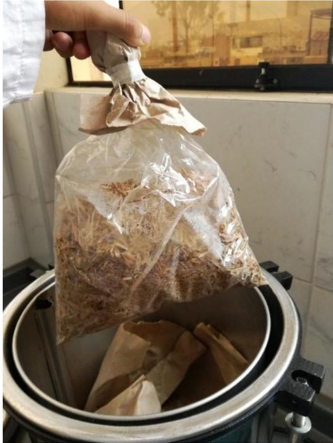
Figura 8. Esterilización de la pajilla de arroz en paquetes
