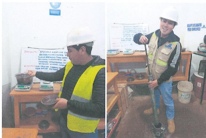
FOTOGRAFÍA N° 06: Ensayos realizados en laboratorio de calicata N° 03: Con adición de 6% de emulsión asfáltica (ensayo próctor modificado) y 9% de emulsión asfáltica (ensayo próctor modificado) respectivamente.
