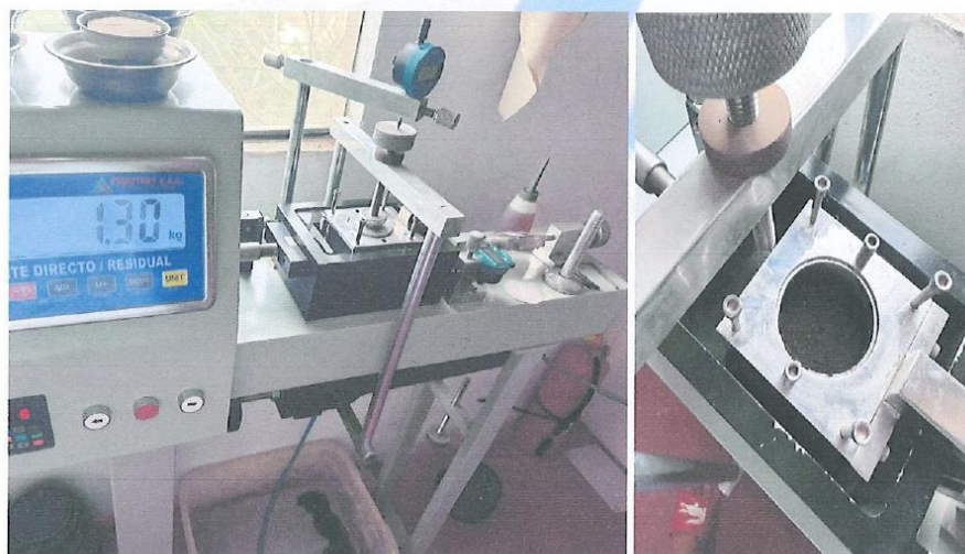
FOTOGRAFÍA N° 13: Ensayo de corte directo realizados en laboratorio de calicatas N° 01, 02, 03, 04, 05, 06: En condiciones naturales, con adición de 3%, 6% y 9% de emulsión asfáltica respectivamente.
