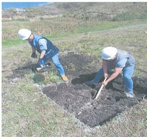
FOTOGRAFÍA N° 01: Excavación para la extracción de muestras de suelo y la posterior realización de ensayos en laboratorio.
