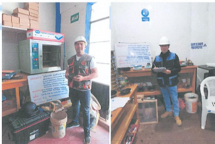
FOTOGRAFÍA N° 01: Ensayos realizados en laboratorio de calicata N° 01: En condiciones naturales (ensayo de contenido de humedad natural) y con adición de 3% de emulsión asfáltica (ensayo de contenido de humedad natural) respectivamente.
