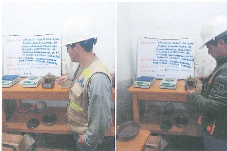
FOTOGRAFÍA N° 10: Ensayos realizados en laboratorio de calicata N° 05: Con adición de 6% de emulsión asfáltica (ensayo de límites de consistencia) y 9% de emulsión asfáltica (ensayo de límites de consistencia) respectivamente.
