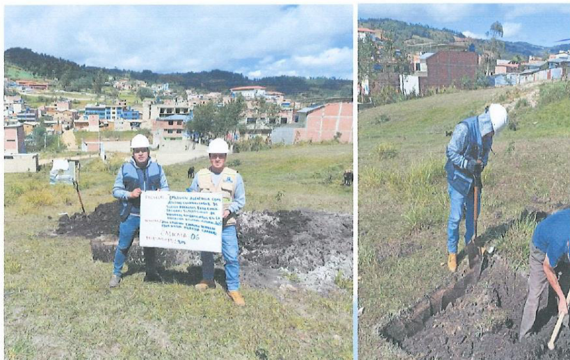
FOTOGRAFÍA N° 07: Excavación y extracción muestras de suelo de Calicata N° 06
