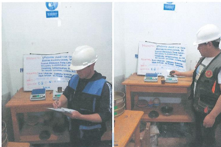
FOTOGRAFÍA N° 04: Ensayos realizados en laboratorio de calicata N° 02: Con adición de 6% de emulsión asfáltica (ensayo de contenido de humedad natural) y 9% de emulsión asfáltica (ensayo de contenido de humedad natural) respectivamente.
