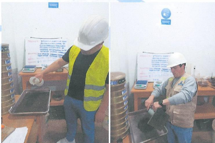
FOTOGRAFÍA N° 09: Ensayos realizados en laboratorio de calicata N° 05: En condiciones naturales (ensayo próctor modificado) y con adición de 3% de emulsión asfáltica (ensayo próctor modificado) respectivamente.
