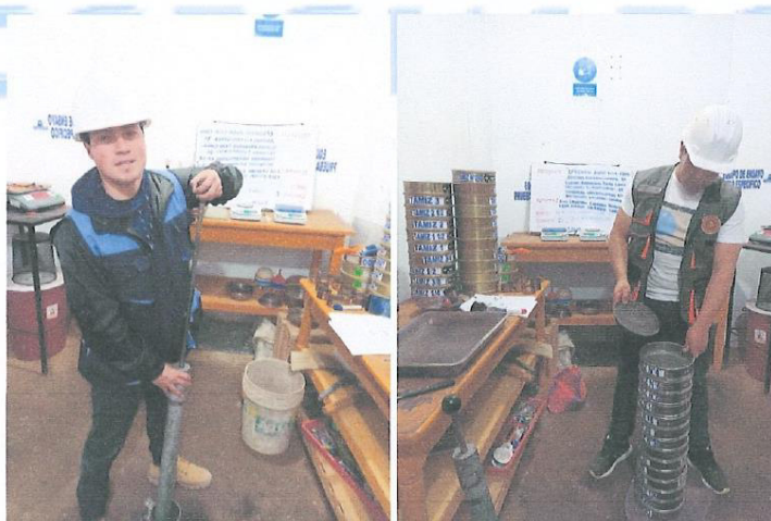
FOTOGRAFÍA N° 03: Ensayos realizados en laboratorio de calicata N° 02: En condiciones naturales (ensayo próctor modificado) y con adición de 3% de emulsión asfáltica (ensayo de análisis granulométrico) respectivamente.
