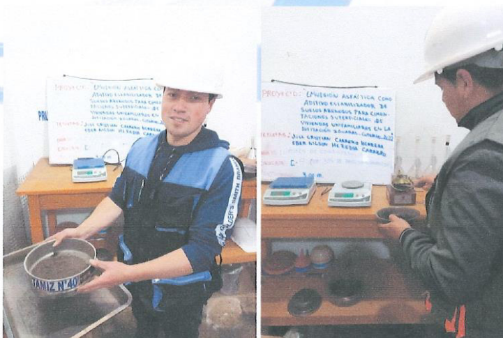
FOTOGRAFÍA N° 07: Ensayos realizados en laboratorio de calicata N° 04: En condiciones naturales (ensayo de límites de consistencia) y con adición de 3% de emulsión asfáltica (ensayo de límites de consistencia) respectivamente.
