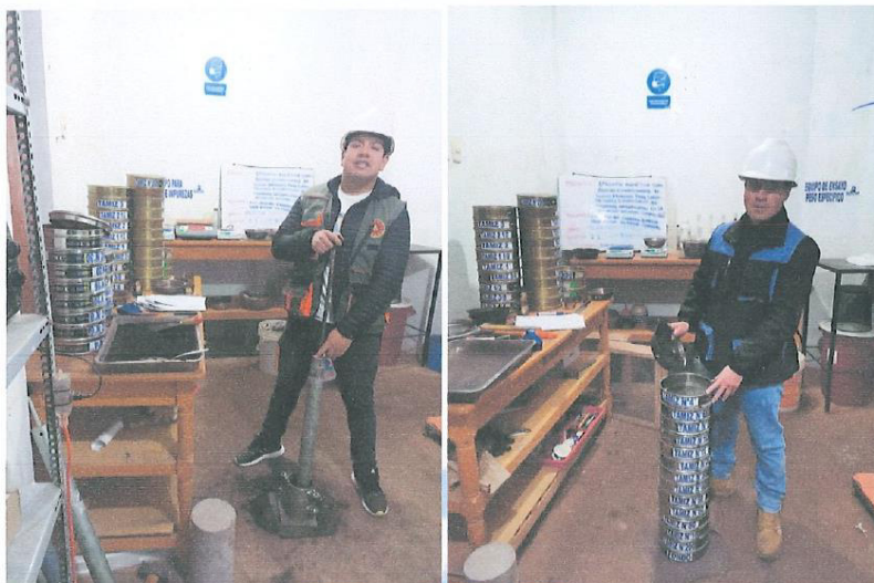
FOTOGRAFÍA N° 02: Ensayos realizados en laboratorio de calicata N° 01: Con adición de 6% de emulsión asfáltica (ensayo de proctor modificado) y 9% de emulsión asfáltica (ensayo de análisis granulométrico) respectivamente.
