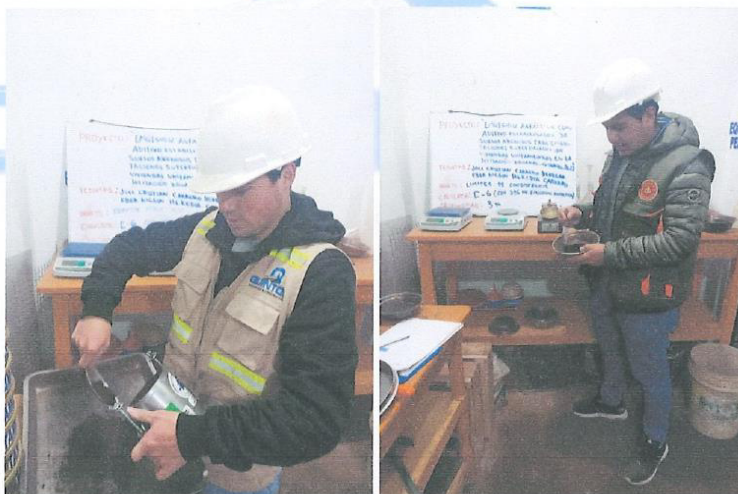
FOTOGRAFÍA N° 11: Ensayos realizados en laboratorio de calicata N° 06: En condiciones naturales (ensayo próctor modificado) y con adición de 3% de emulsión asfáltica (ensayo de límites de consistencia) respectivamente.
