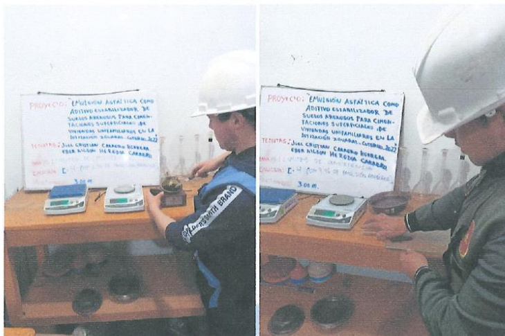
FOTOGRAFÍA N° 08: Ensayos realizados en laboratorio de calicata N° 04: Con adición de 6% de emulsión asfáltica (ensayo de límites de consistencia) y 9% de emulsión asfáltica (ensayo de límites de consistencia) respectivamente.
