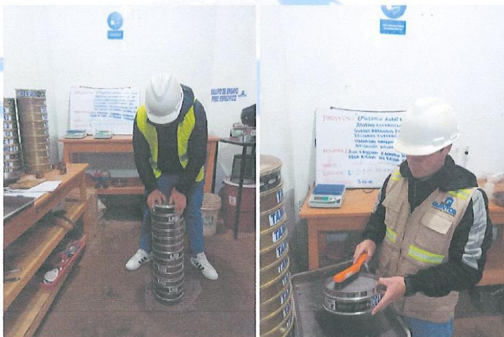
FOTOGRAFÍA N° 05: Ensayos realizados en laboratorio de calicata N° 03: En condiciones naturales (ensayo de análisis granulométrico) y con adición de 3% de emulsión asfáltica (ensayo de análisis granulométrico) respectivamente.
