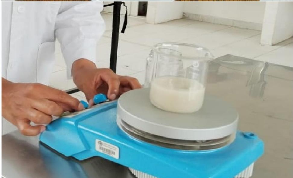
*Nota:* Fraccionamiento y preparación de las partículas de arcilla del Chak'ó.
