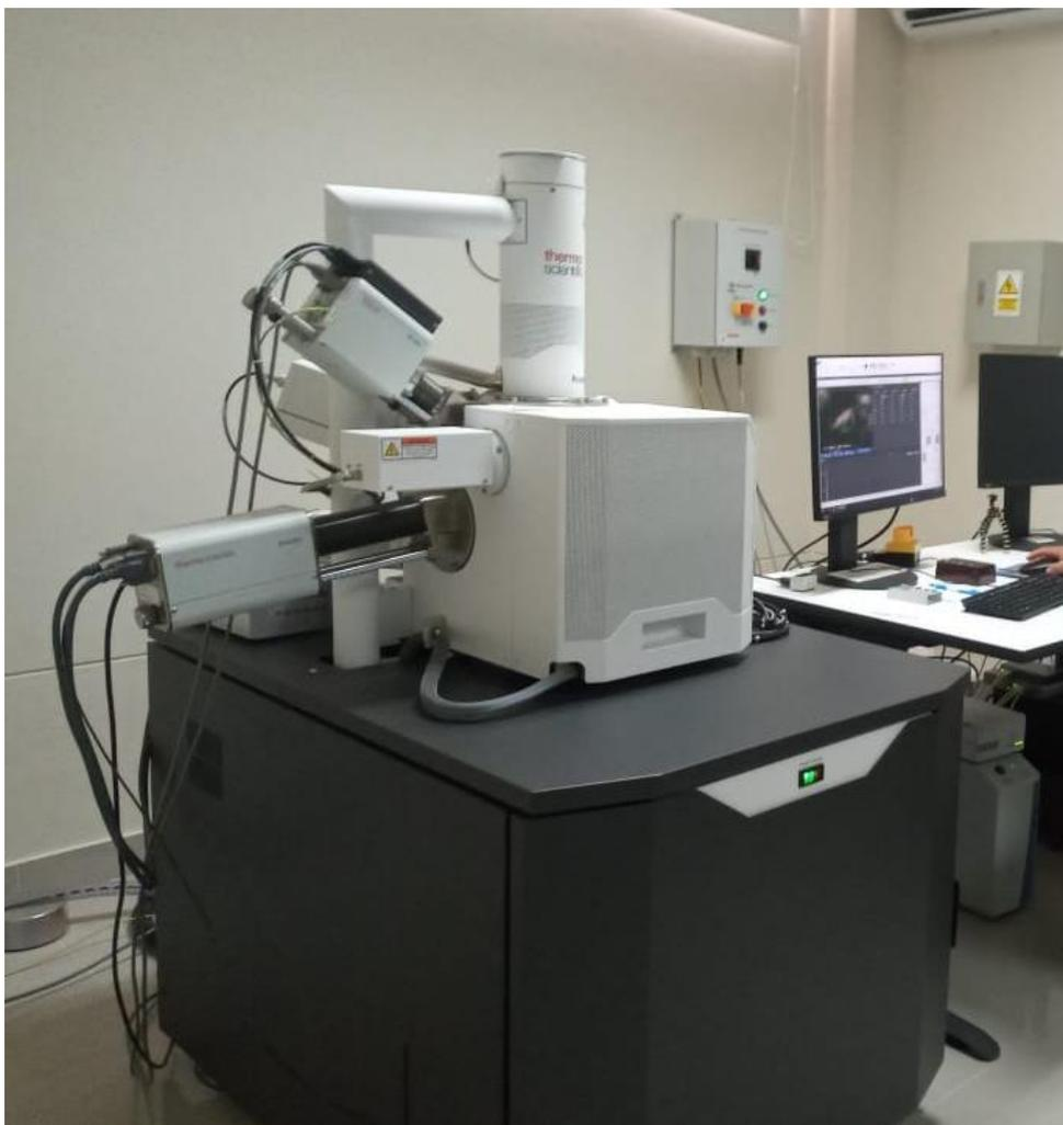
*Nota:* Microscopio electrónico de barrido usado en la investigación.
