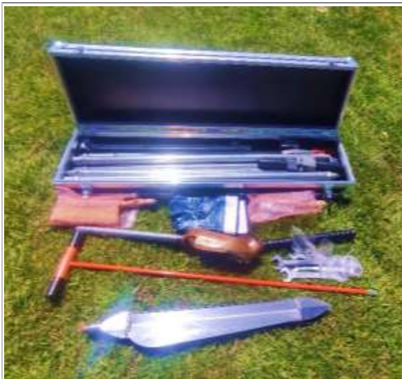
Imagen 1. Muestreador (Russian peat corer)
