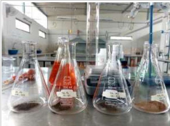
Imagen 19. Muestras iniciales de turba para la aplicación del método de Walkley de Balck.
