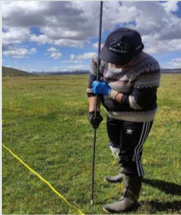
Imagen 5. Medición manual de profundidad de turba.
