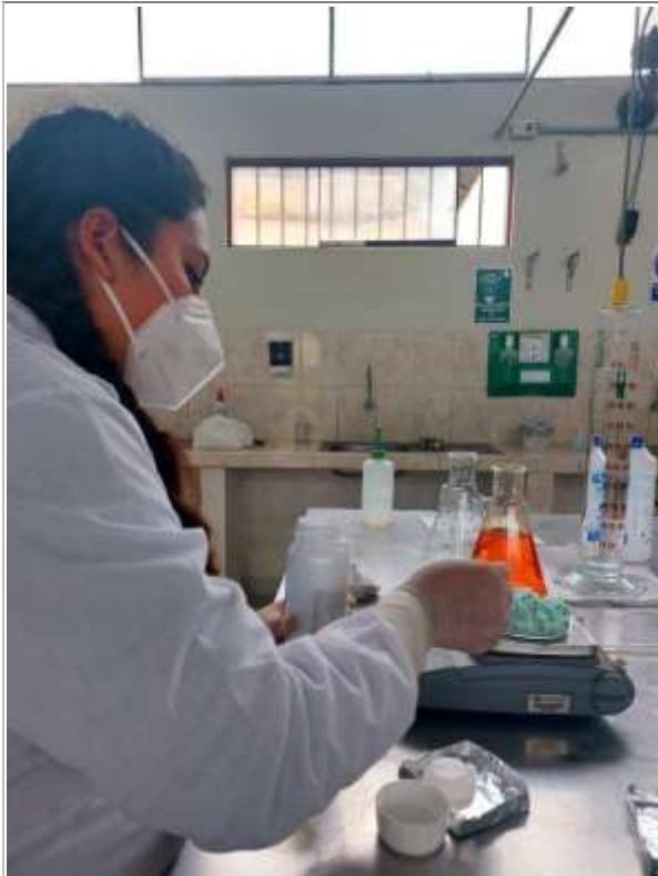
Imagen 17. Preparación de reactivos que serán usados para el análisis de carbono mediante el método de Walkley y Black.
