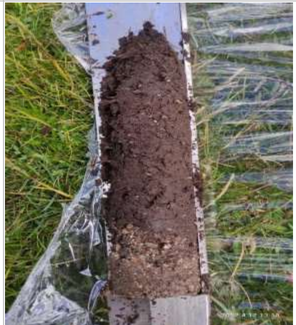
Imagen 8. Muestra de Turba extraída empleando el Muestreador (Russian peat corer).
