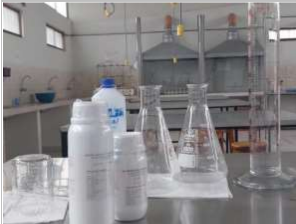
Imagen 12. Materiales e insumos necesarios para la aplicación del método de Walkley y Black.
