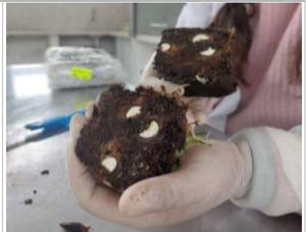
Imagen 13. Muestra de turba entre los 0 a 15 cm de profundidad.
