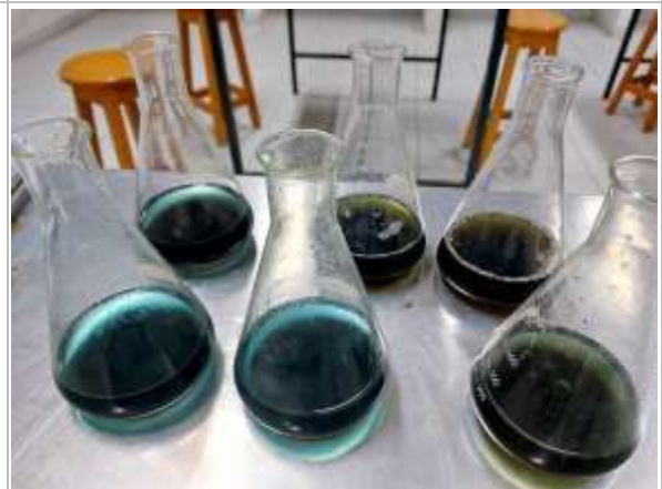
Imagen 20. Muestras finales del proceso de aplicación del método de Walkley y Black.
