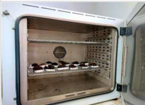
Imagen 14. Secado de Muestras en un horno a temperatura constante durante 24 horas.
