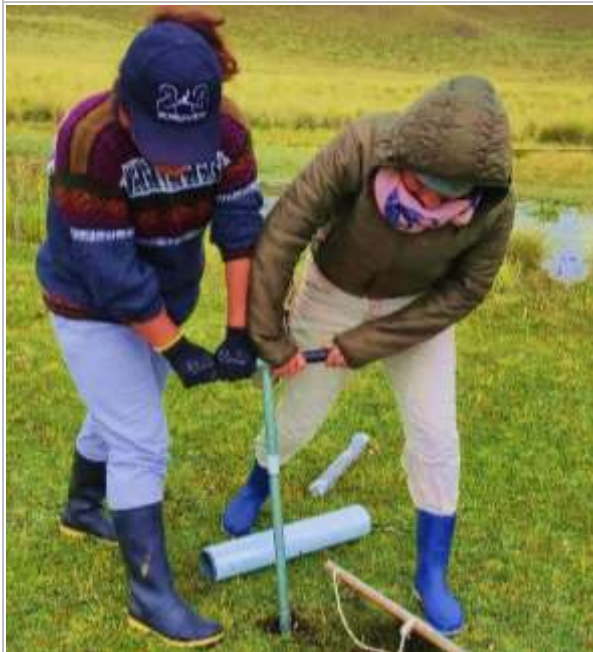
Imagen 7. Extracción de turba empleando el Muestreador (Russian peat corer)
