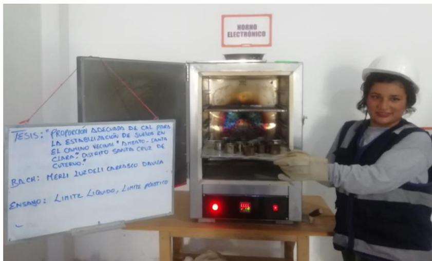
*Nota.* Fotografía tomada en el laboratorio**Ensayo para determinar el contenido de humedad natural****Figura 11***Contenido de humedad*
