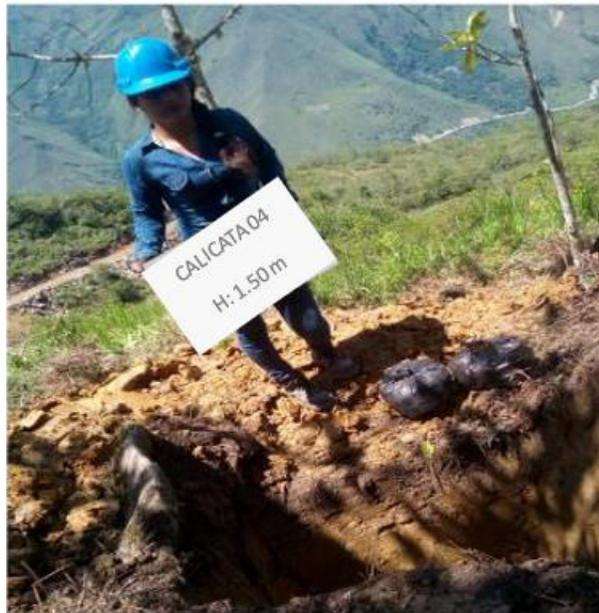
*Nota.* Toma personal, observamos las muestras extraídas de la calicata 04 colocadas en bolsas para los ensayos de caracterización.
