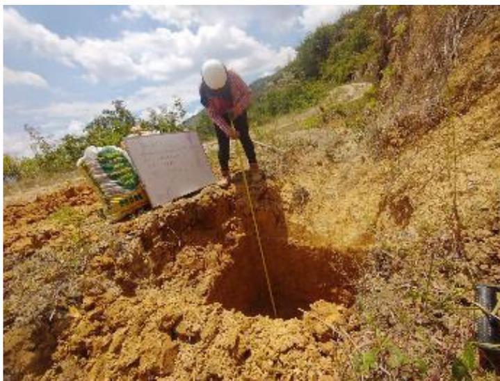
*Nota.* Toma personal, en la fotografía podemos observar que se está midiendo la profundidad de excavación que se tiene para extraer muestras de suelo.
