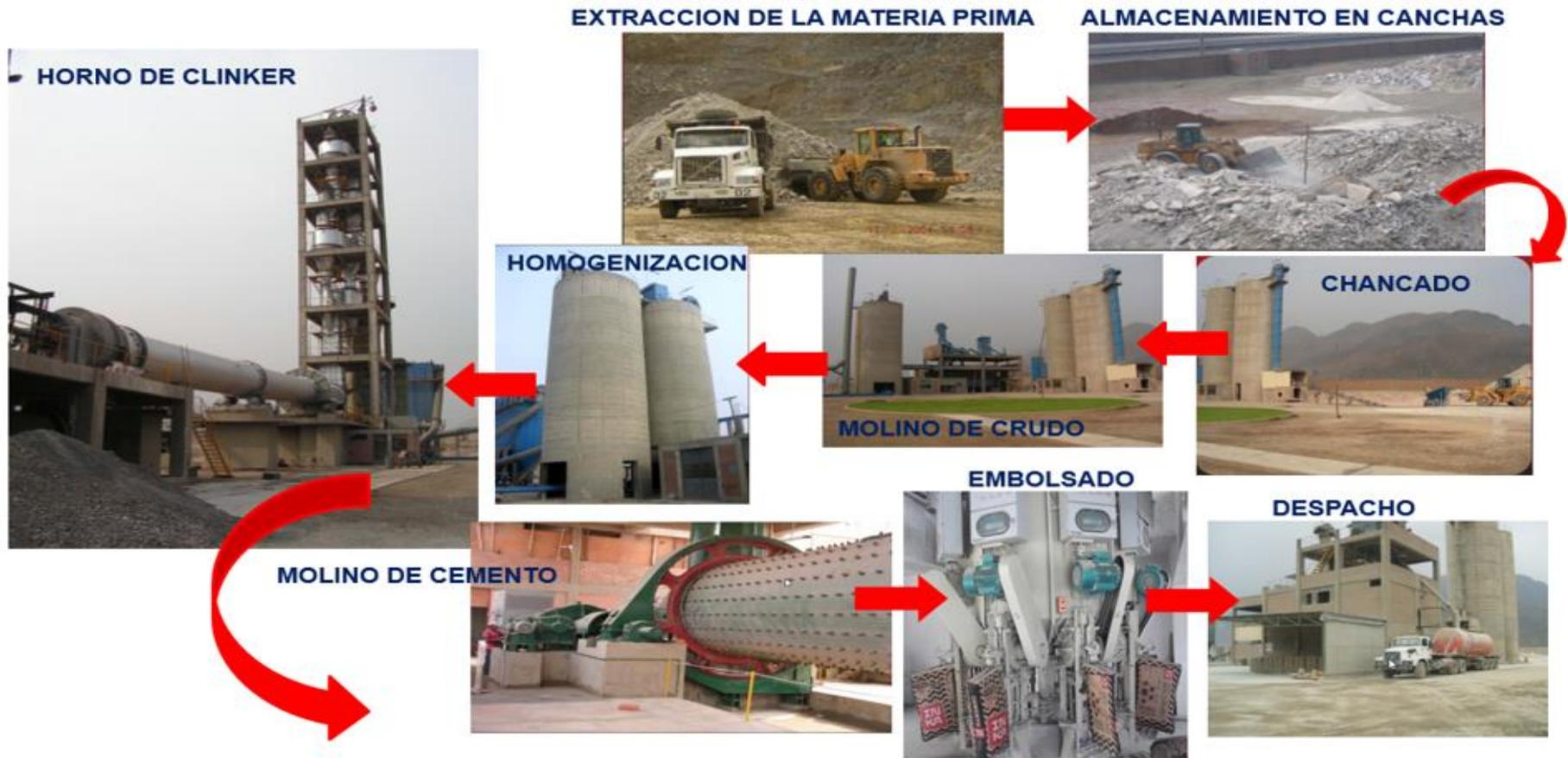
Figura 3: Proceso de Fabricación del Cemento
