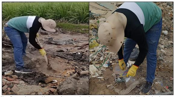
Nota. Proceso de excavación y toma de muestra de suelo posterior a la homogenización de cada submuestra.
