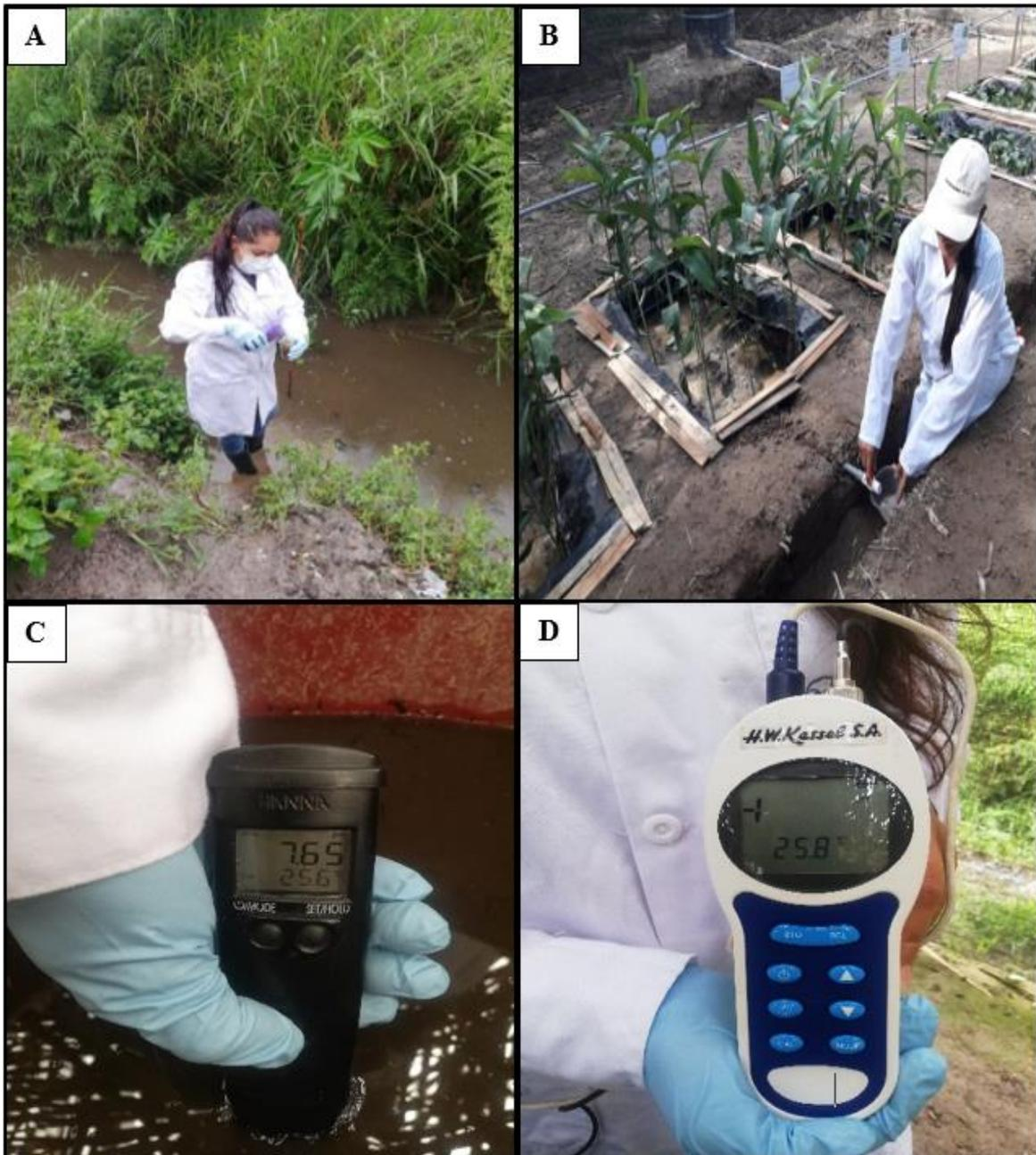
*Nota.* (A) Toma de muestras del efluente del botadero. (B) Toma de muestras de los humedales después del tratamiento. (C) Medición de pH de las muestras de lixiviado. (D) Medición de la temperatura de las muestras de lixiviado.
