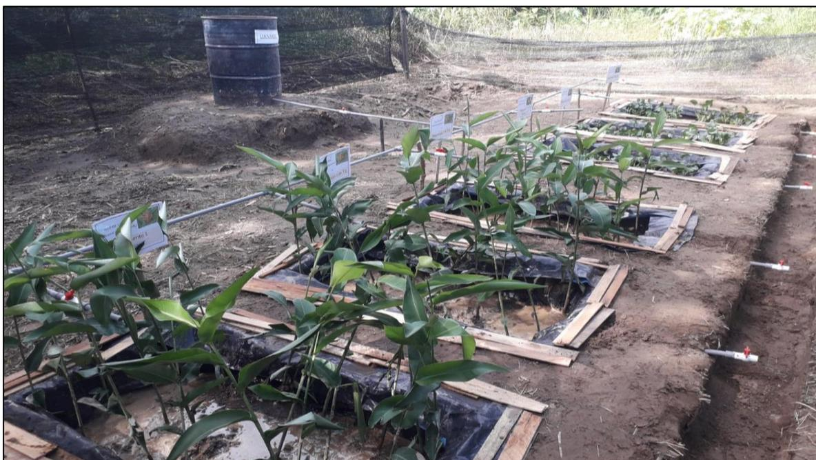
Asimismo, se empleó como flujo de agua el lixiviado en los tratamientos con plantas flotantes equivalente a tres tiempos de retención hidráulica, que fue de 12, 24 y 36 horas respectivamente. La selección y cantidad de especies se basó en la facilidad de mantener, bajo clima y calidad de agua residual de la zona, especies propiamente nativas y fácil adaptación en el cultivo y propagación en invernadero (Pérez, 2009).
