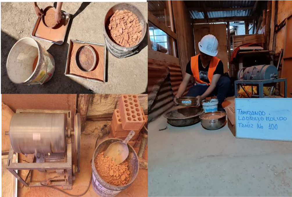
Fotografía 6 pulverización del ladrillo
