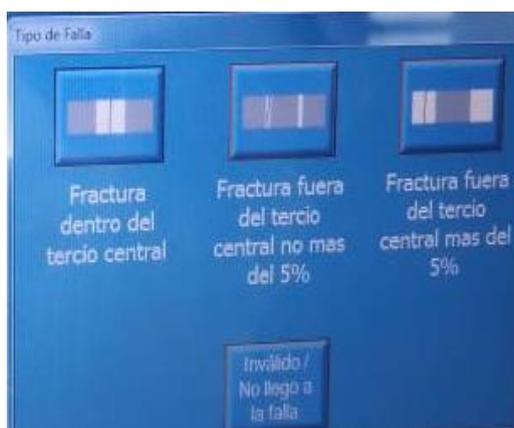
*Nota.* Se muestran los tres tipos de fallas que pueden presentar los testigos tipo viga que son sometidos al esfuerzo a flexión.
