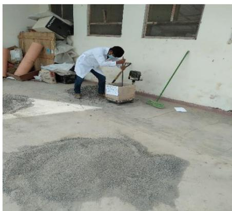
*Nota.* El ensayo del peso unitario varillado del agregado grueso (piedra chancada) de la cantera cerro Calero en un cubo de madera de volumen de  $0,0283 \text{ m}^3$ .
