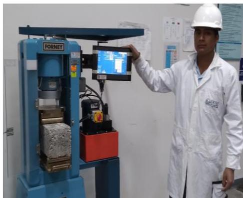
*Nota.* Prensa hidráulica donde se realizaron los ensayos a los esfuerzos a flexión de las vigas de concreto, en el laboratorio de la Universidad Católica Sedes Sapientiae.
