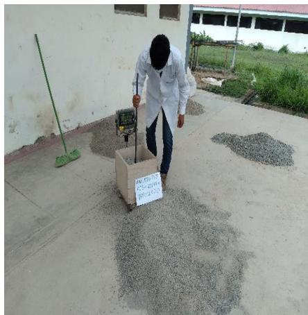
*Nota.* El ensayo del peso unitario varillado del agregado fino de la cantera Cerro Calero, se realizó en el laboratorio del Proyecto Especial Alto Mayo en Nueva Cajamarca. Se empleó un cubo de madera de volumen de  $0,0283 \text{ m}^3$ .
