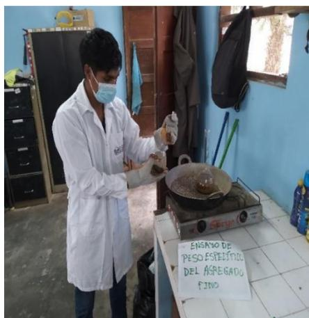
*Nota.* El ensayo del peso específico del agregado fino se empleó el método de la fiola.
