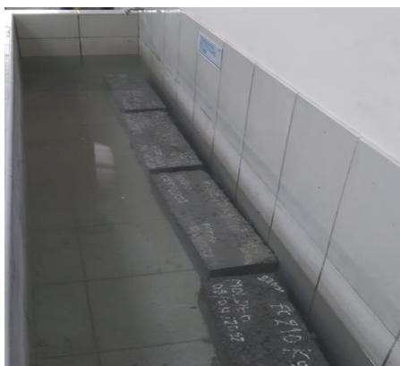
*Nota.* La saturación de los testigos de concreto de forma de viga se realizó en el laboratorio de la Universidad Católica Sedes Sapientiae del distrito de Nueva Cajamarca.
