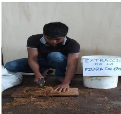
*Nota.* Extracción de fibras de coco de forma manual
