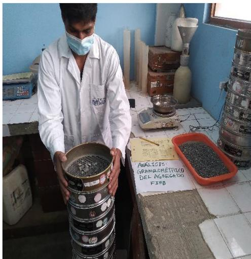
*Nota.* El ensayo granulométrico del agregado fino (arena) se realizó en el laboratorio del Proyecto Especial Alto Mayo en el distrito de Nueva Cajamarca.
