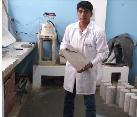
*Nota.* En el ensayo de esfuerzos a la compresión se realizaron el laboratorio del Proyecto Especial Alto Mayo. Se observa el tipo de falla (corte) a la compresión del testigo de concreto después de haber sido sometido a los esfuerzos de compresión.
