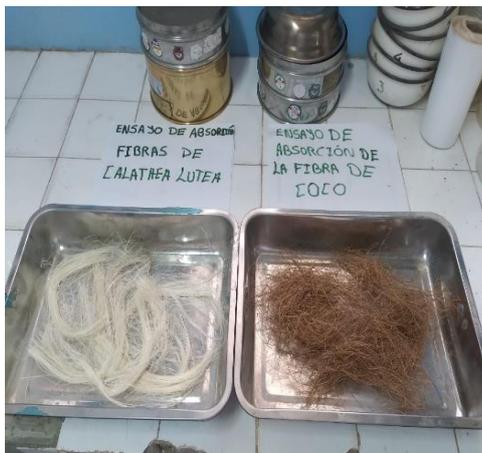
*Nota.* El ensayo de absorción de las fibras de coco y *Calathea Lutea* se realizó en el laboratorio del Proyecto Especial Alto Mayo del distrito de Nueva Cajamarca.
