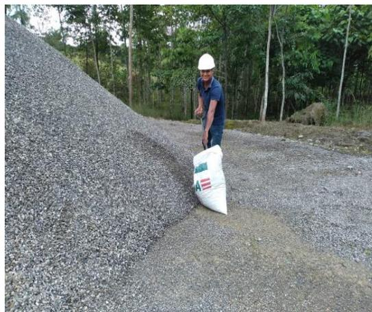
*Nota.* Recolección en sacos de las muestras del agregado grueso (piedra chancada) de la cantera Cerro Calero para realizar los ensayos de laboratorio y el diseño de mezcla de concreto hidráulico de  $f'c = 210 \text{ kg/cm}^2$ .
