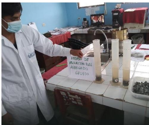
*Nota.* El ensayo de absorción del agregado grueso se aplicó el método de probetas realizadas en laboratorio del Proyecto Especial Alto Mayo del distrito de Nueva Cajamarca.
