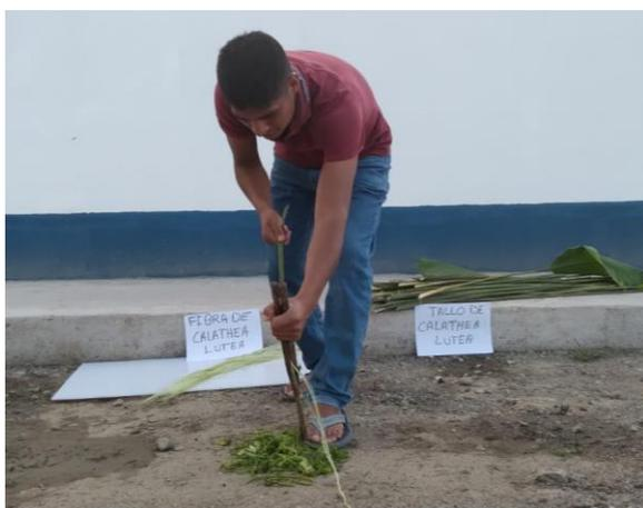
*Nota.* Extracción de forma manual de la fibra de la *Calathea Lutea*, utilizando dos varillas lisas de acero.
