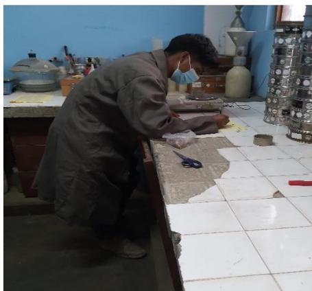
*Nota.* Determinación del peso de la muestra de la fibra de coco para el ensayo de la humedad natural realizados en el laboratorio del Proyecto Especial Alto Mayo en el distrito de Nueva Cajamarca.
