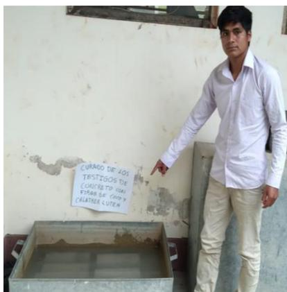
*Nota.* La saturación de los testigos de concreto convencionales y adicionados fibras se realizó en el laboratorio del proyecto especial Alto Mayo del distrito de Nueva Cajamarca.
