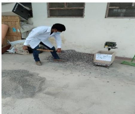
*Nota.* El ensayo del peso unitario suelto del agregado grueso (piedra chancada) de la cantera Cerro Calero en un cubo de madera de volumen de  $0,0283 \text{ m}^3$ .
