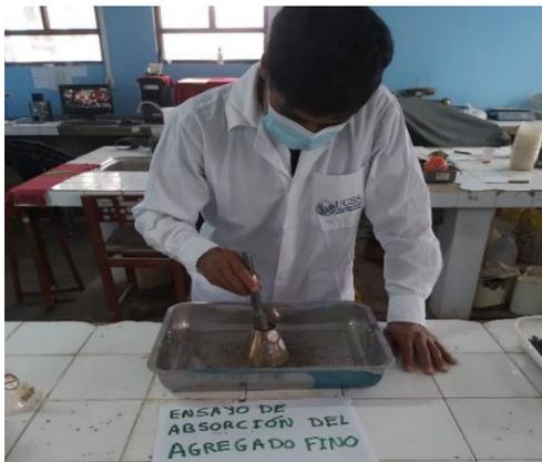
*Nota.* El ensayo de absorción del agregado fino (arena) de la cantera Cerro Calero se realizó mediante el método del cono.
