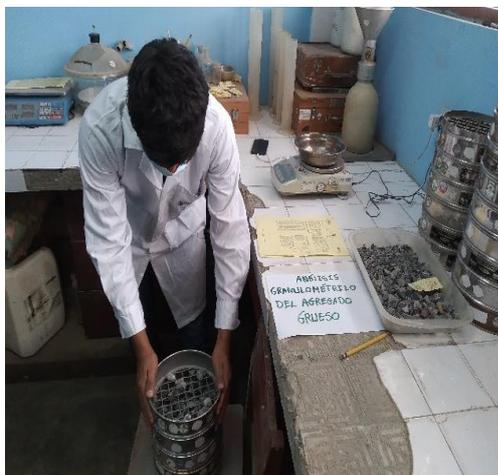
*Nota.* El ensayo granulométrico del agregado grueso (piedra chancada) se realizó en el laboratorio del Proyecto Especial Alto Mayo en el distrito de Nueva Cajamarca.
