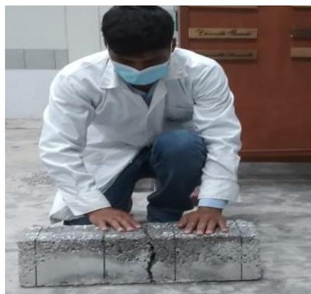
*Nota.* Viga de concreto que ha sido sometida al esfuerzo de flexión presenta el tipo de falla dentro del tercio central de la viga.
