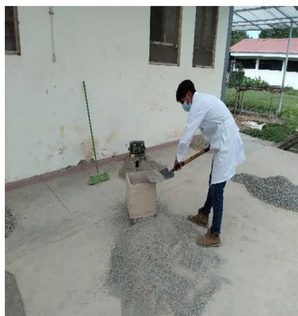
*Nota.* El ensayo del peso unitario suelto del agregado fino (arena) de la cantera Cerro Calero, se realizó en el laboratorio del Proyecto Especial Alto Mayo en Nueva Cajamarca. Se utilizó un cubo de madera de volumen de  $0,0283 \text{ m}^3$ .
