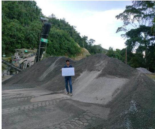
*Nota.* Punto de acopio y toma de muestras del agregado fino (arena) de la cantera Cerro Calero para realizar los ensayos de laboratorio y diseño de mezcla de concreto hidráulico de  $f'c = 210 \text{ kg/cm}^2$ .
