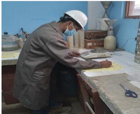
*Nota.* Determinación del peso de la muestra de los agregados para el ensayo de la humedad natural realizados en el laboratorio del Proyecto Especial Alto Mayo en el distrito de Nueva Cajamarca.
