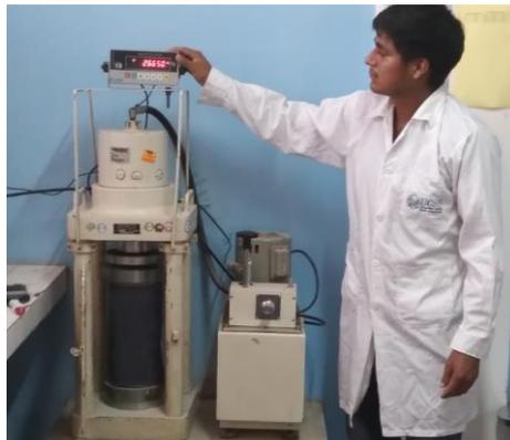
*Nota.* Prensa digital para la realización del ensayo a compresión de los testigos de concreto.
