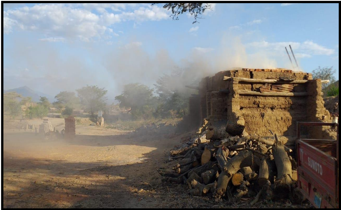
Cocción de los bloques de ladrillo
