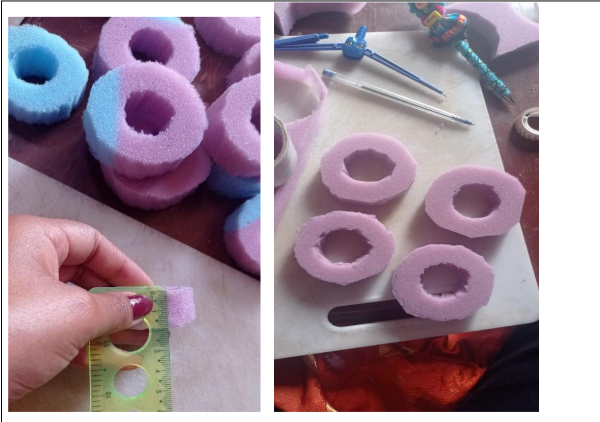
Nota. Elaboración del medio filtrante (medición y corte de la esponja zebra según medidas necesarias para el sistema DHS G – 6).
