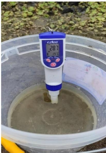
Medición de oxígeno disuelto y temperatura in situ
