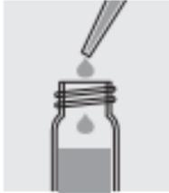
Añadir 2,0 ml **Vario Sodium hydroxide 1.54 N** con una pipeta, cerrar la cubeta con el tapón roscado y mezclar.
