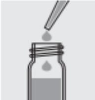
Agregar muy lentamente 1,5 ml de la muestra preparada con la pipeta, cerrar la cubeta con el tapón roscado y mezclar enérgicamente. **Cuidado, la cubeta se calienta mucho!**
