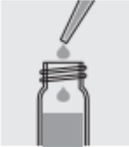
Con una pipeta añadir 5 ml de la muestra en una cubeta de reacción y cerrar la cubeta con el tapón roscado.
