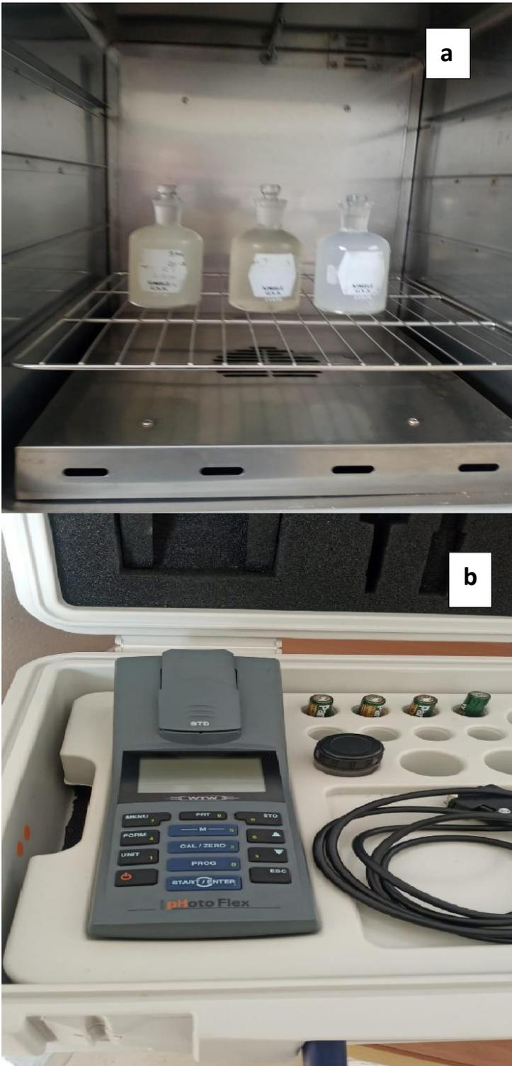
Equipos e instrumentos usados en la caracterización fisicoquímica. a. Incubadora con frascos Winkler para determinar la DBO. b. Fotómetro
