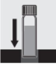
Dentro de 8 minutos después de haber añadido el reactivo: Colocar la cubeta en el compartimiento del fotómetro e iniciar la medición.
