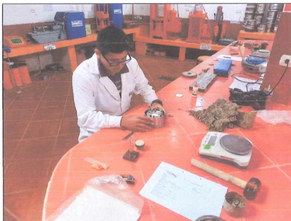
Fotografía 28. Se realiza el armado de la celda de confinamiento del ensayo de consolidación.
