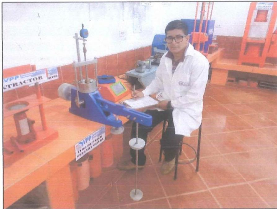
Fotografía 29. Se realiza la lectura de los asentamientos dado inicio al ensayo de consolidación.
