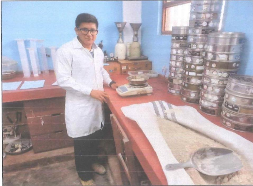
Fotografía 11. Se observa el pesado de los materiales (500 gramos) para los ensayos de granulometría.
