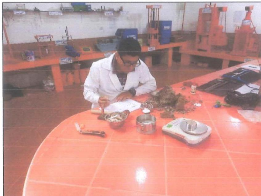
Fotografía 27. Se realiza el pesado de la muestra moldeada para el ensayo de consolidación.
