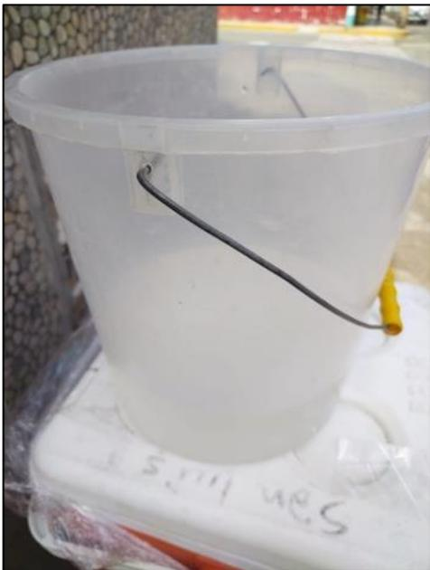
*Nota.* Fotografía del agua colectada proveniente de la descarga final y extracción de muestra de agua residual del restaurante Ya Pez Gringo. Elaboración propia.
