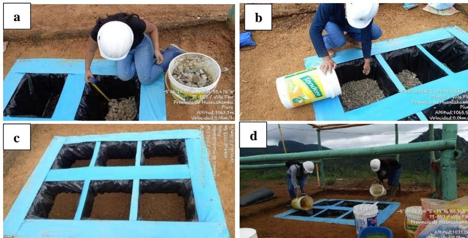
*Nota.* **a.** Colocación de piedra mediana, **b.** Colocación de grava, **c.** Tierra y **d.** Llenado de unidades experimentales con agua residual.
