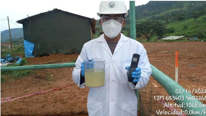
Nota. Calibración de multiparámetro para toma de análisis fisicoquímicos del agua residual.
