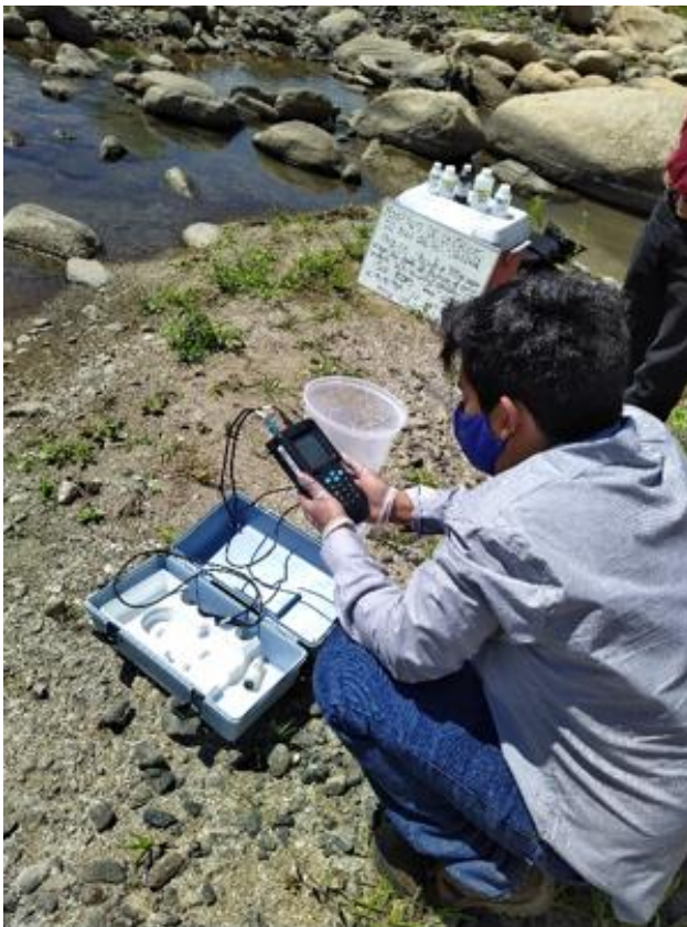
Nota. Medición in situ de variables: temperatura, pH, conductividad eléctrica y oxígeno disuelto, con el equipo multiparámetro.
