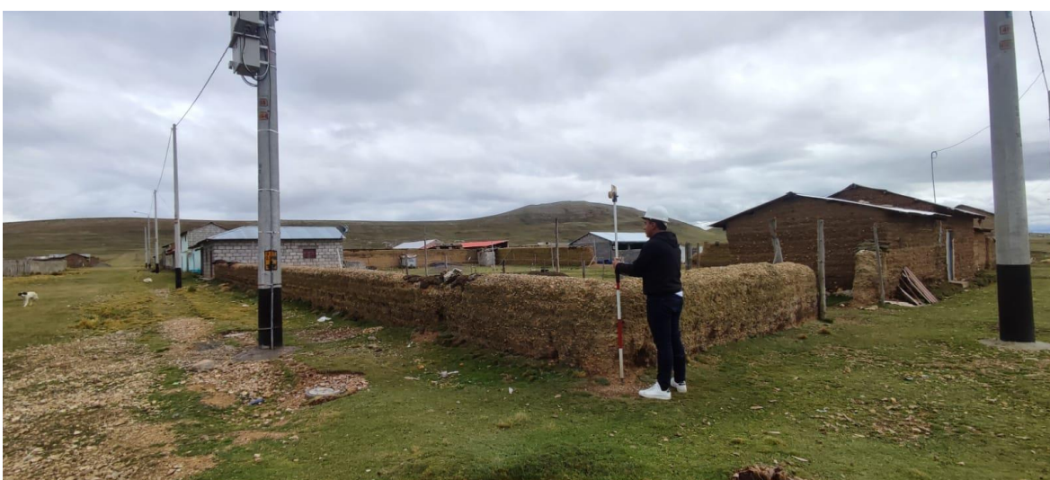
Fotografía 5. Levantamiento topográfico de los lotes de terreno.
