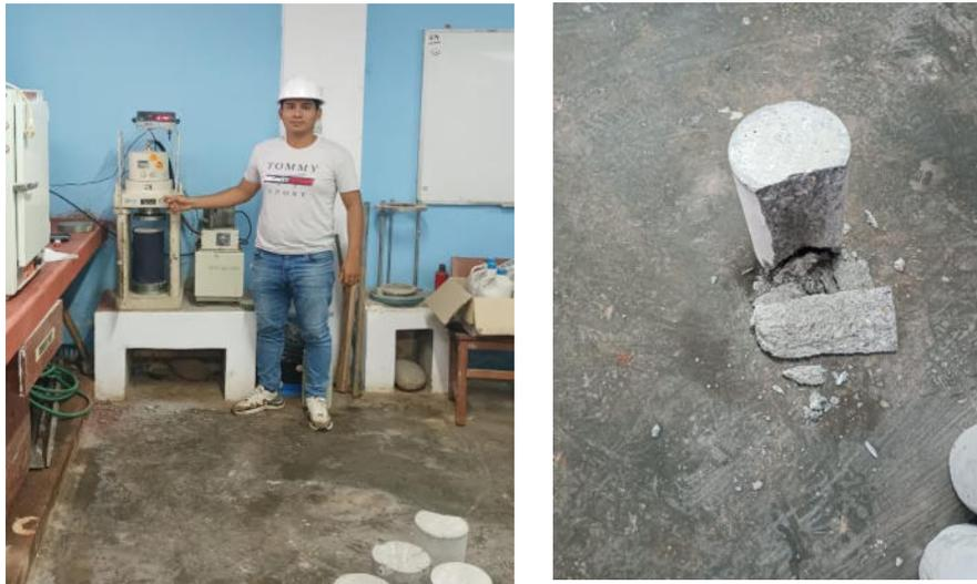
*Nota.* Se realizó el ensayo de ruptura de concreto a los 28 días para verificar la resistencia real dosificada.
