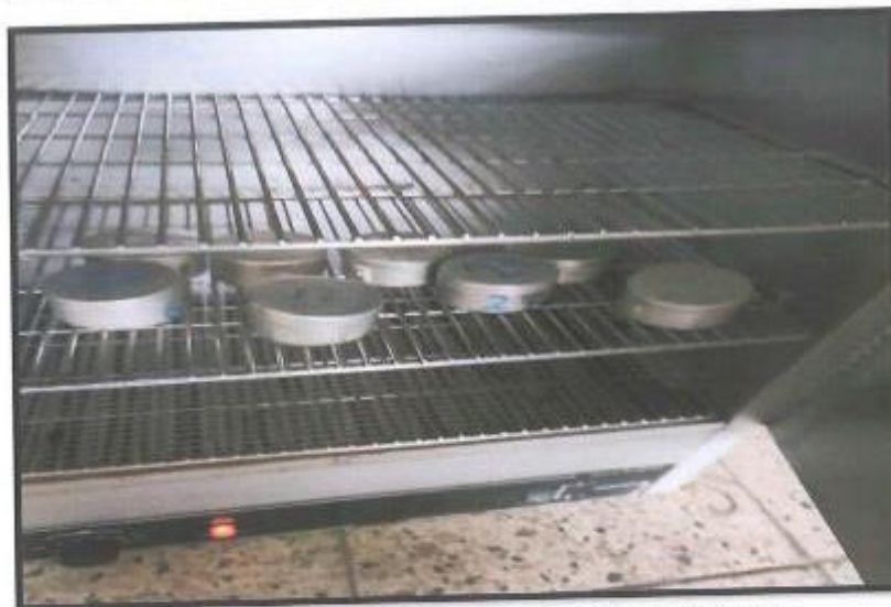
ENSAYO DE CONTENIDO DE HUMEDAD NATURAL
