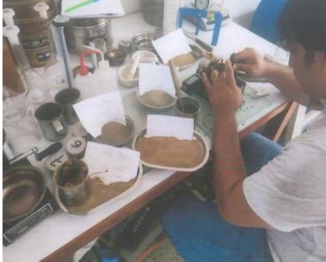
Ensayo de límite líquido (LL)
