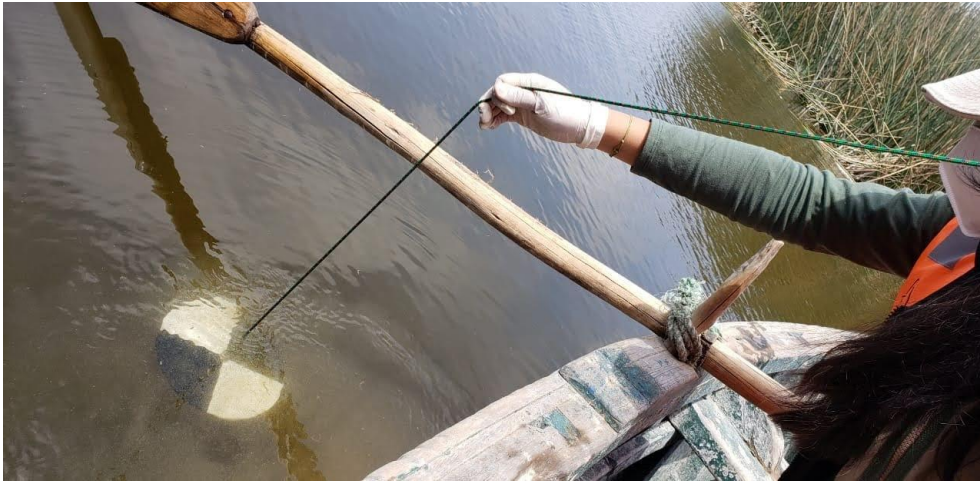
Apéndice 15. Midiendo la transparencia del agua con la ayuda del disco de Secchi en la laguna norte
