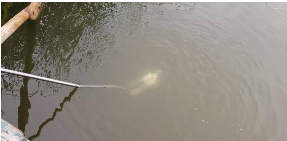
Apéndice 17. Recogiendo muestras de agua con la ayuda del brazo muestreador
