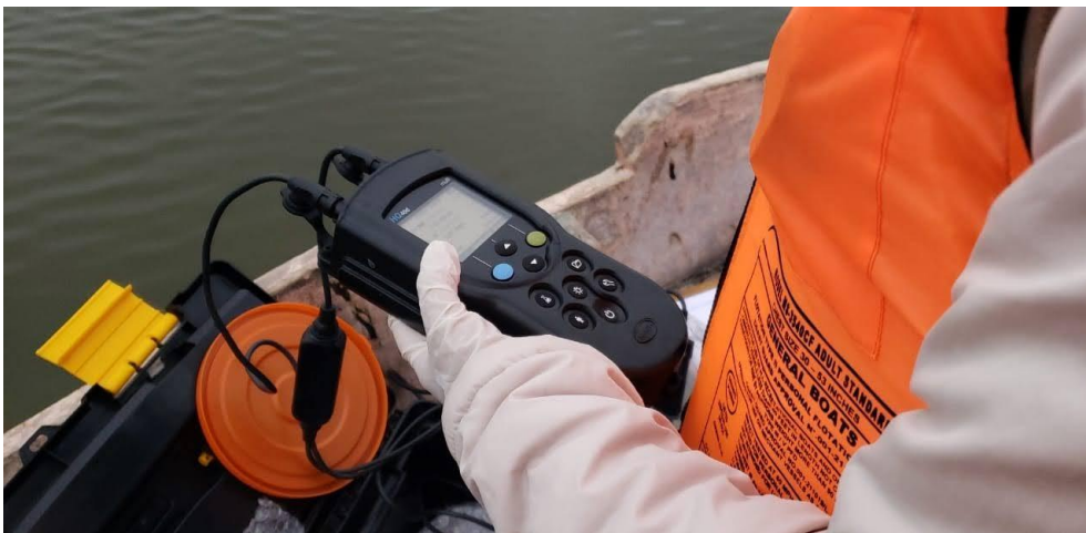
Apéndice 16. Usando el multiparámetro para la medición de parámetros in situ
