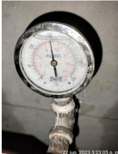
*Nota.* En la figura 15 se muestra la realización de prueba hidráulica a 150 psi. Elaboración propia.
