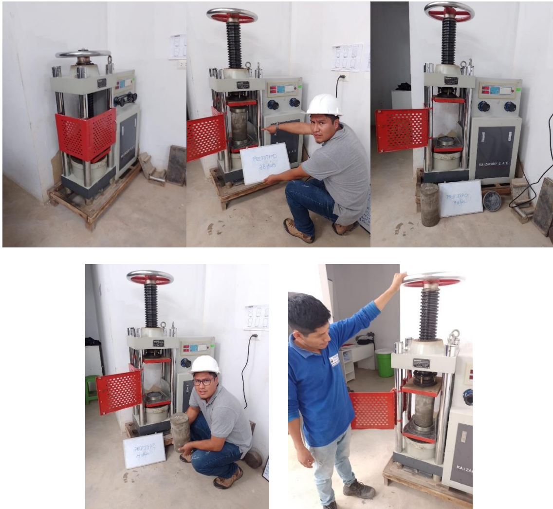
Fotografía A13. Vista realización de los ensayos a compresión a los 7, 14 y 28 días, con el concreto convencional, con el 10%, 15% y 20% de relave en sustitución al agregado de hormigón.
