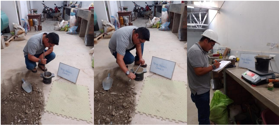
Fotografía A7. Vista proceso de muestra para el peso unitario compactado.
