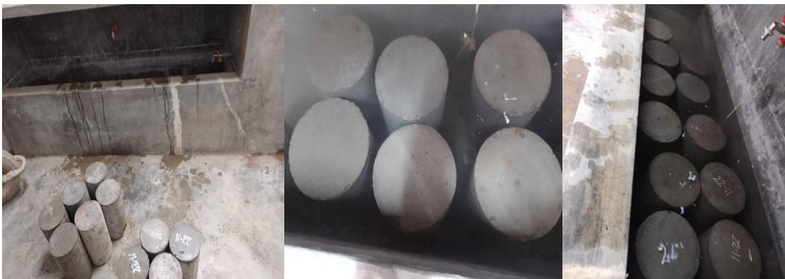
Fotografía A12. Vista proceso del curado de las muestras realizadas del concreto convencional, con el 10%, 15% y 20% de relave en sustitución al agregado de hormigón.
