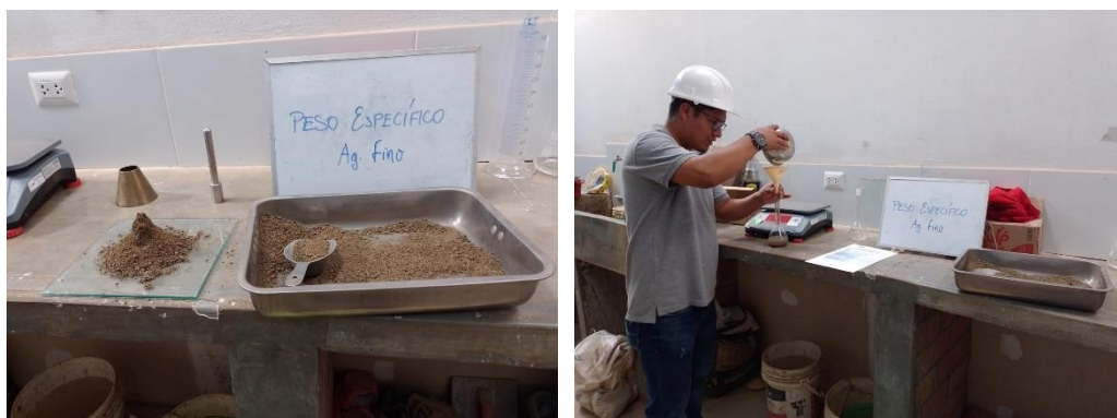
Fotografía A9. Vista peso específico y absorción del agregado fino y comprobación si el agregado fino es óptimo.
