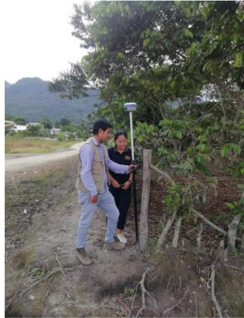
**Fotografía N° 10:** Toma de puntos con el ROVER.
