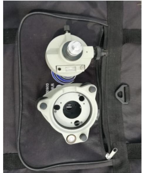
**Fotografía N° 02:** Base nivelante con plomada óptica.
