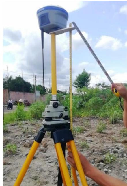
**Fotografía N° 08:** Medición de la altura de la BASE.
