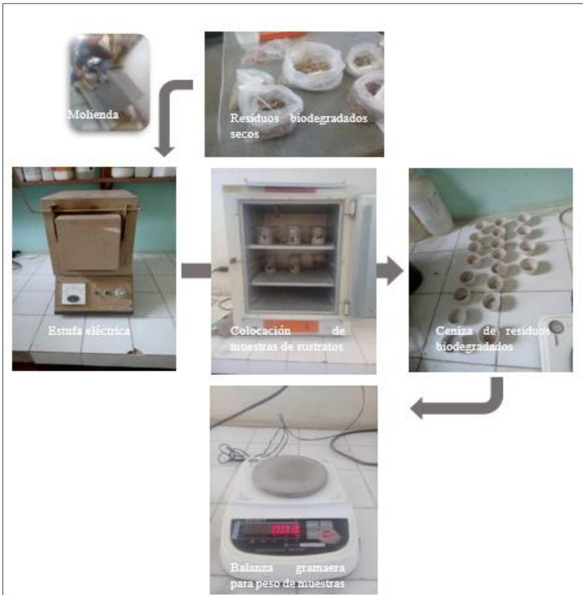
**Figura 14. Proceso para determinar la biodegradación de la materia lignocelulósica a nivel de laboratorio. Fuente: Elaboración propia.**
