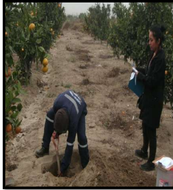
Fotografía 2. Construcción de una calicata
