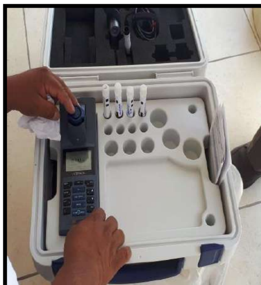
Fotografía 12. Lectura de las muestras para la determinación del cadmio
