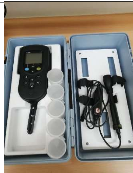
Multiparámetro HACH HQ40d, con sonda de Oxígeno Disuelto (OD)
