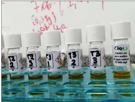
Tubos de digestión para DQO, con un rango de 20-800 mg/L
