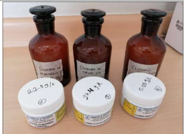
Preparación de soluciones nutritivas (reactivos utilizados en la preparación del agua de dilución para DBO_5 ).
