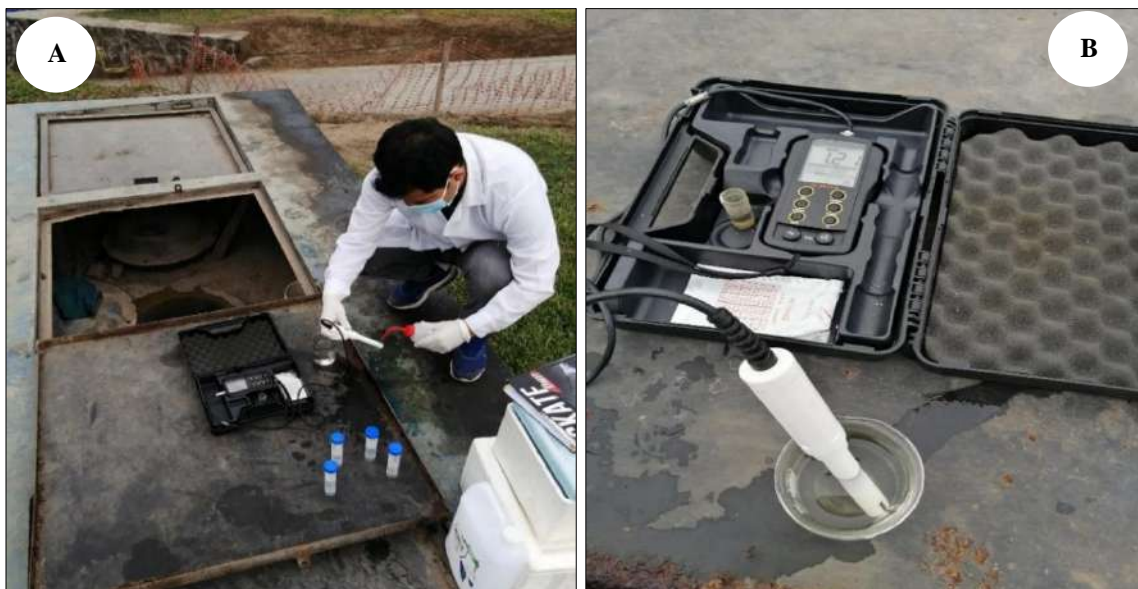
Figura 14. Medición de los parámetros de campo. A: Limpieza del electrodo tras cada medición. B: Determinación de la conductividad eléctrica con equipo ANNA modelo HI 9813-6 previamente calibrado.
