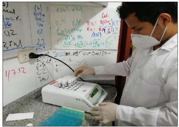
Calentamiento de tubos de digestión de DQO en termorreactor Rocker modelo CR-25
