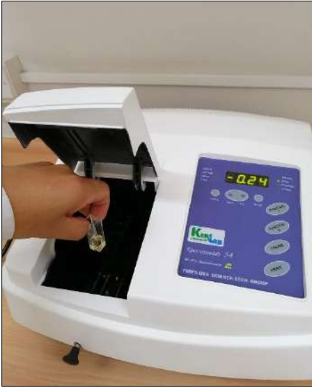
Medición de niveles de absorbancia en el espectrofotómetro UV-visible.
