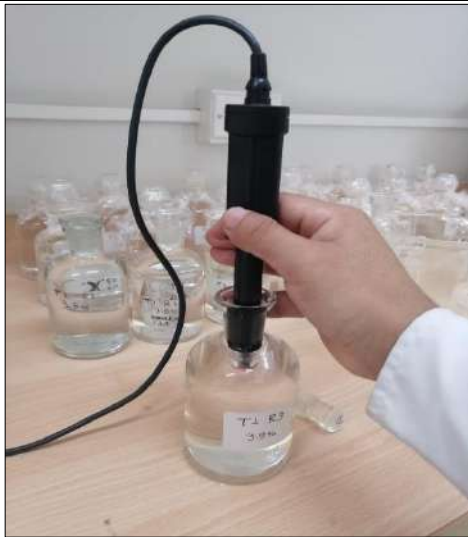
Determinación de Oxígeno Disuelto (OD) en frascos Winkler, con equipo HACH
