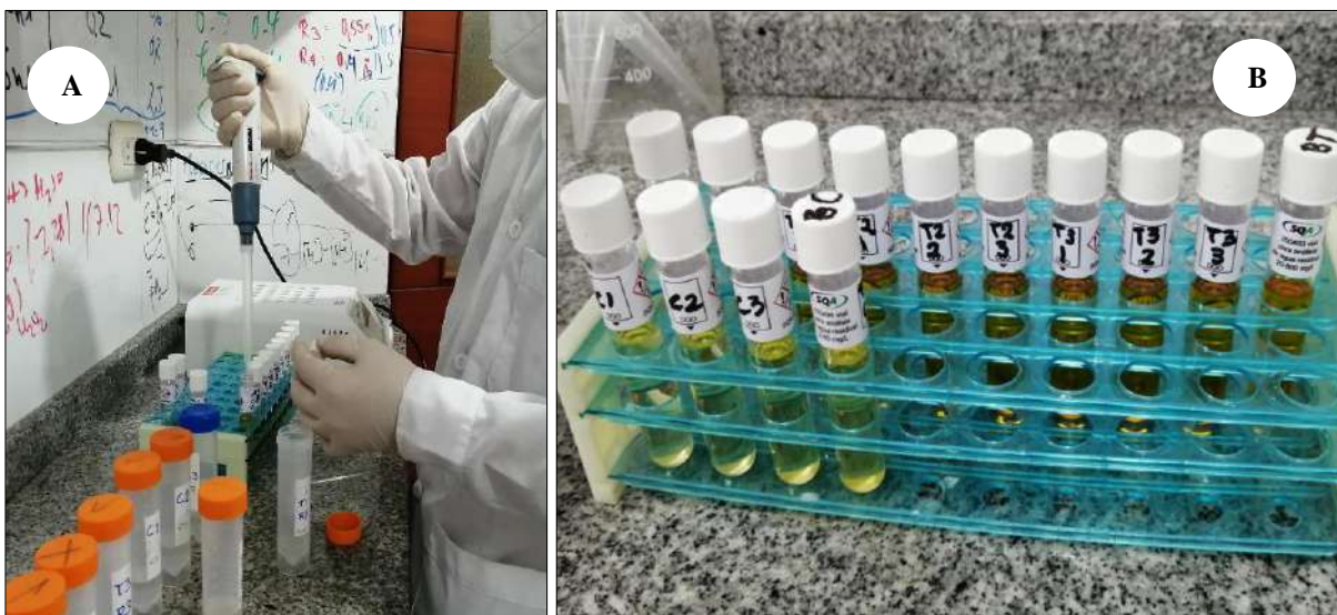
Figura 22. A: Vertido de 2,5 ml de agua muestra en cada vial. B: Viales de DQO con intervalos de 2-80 mg/L (ubicados adelante) y 20-800 mg/L (ubicados atrás), antes del proceso de termorreacción.
