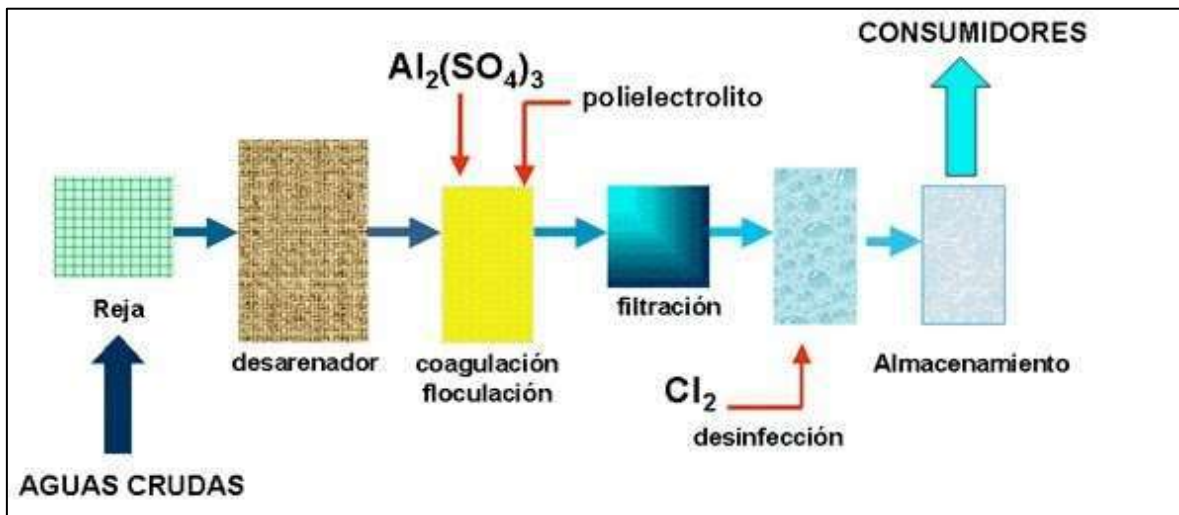
Apéndice 09. Diagrama de flujo de Potabilización de agua.
