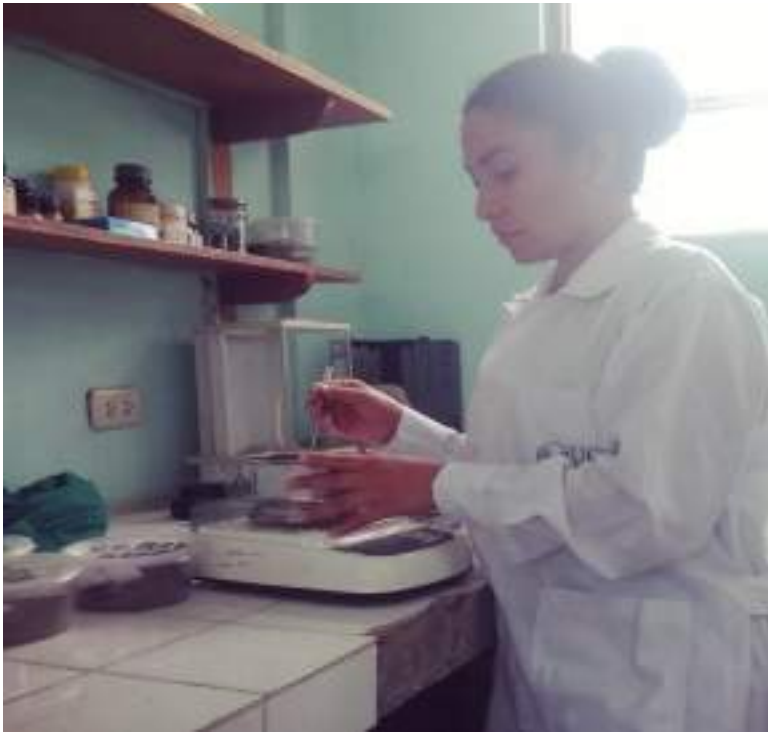
Imagen 7. Pesado de la tierra tamizada en la balanza eléctrica en el laboratorio de suelos PEAM.
