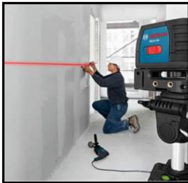
Figura 21: Proyección de nivel con láser
