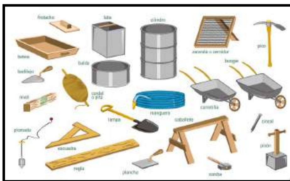
Figura 3: Herramientas empleados en construcción
