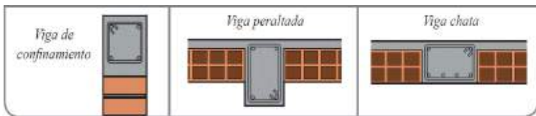
Figura 3. Tipos de viga.
