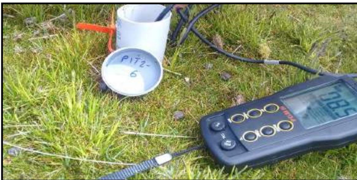
*Figura 7.* Toma de datos *in situ* (pH, conductividad eléctrica y temperatura). *Fuente:* Elaboración propia.
