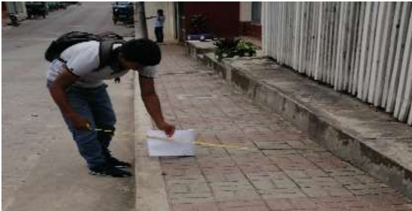
Fotografía 11: Verificando accesibilidad a aceras peatonales en vías pavimentadas por manzana, en el Jr. Angaiza - Barrio de Consuelo con estructura de material adoquinado de 1.75 m.
