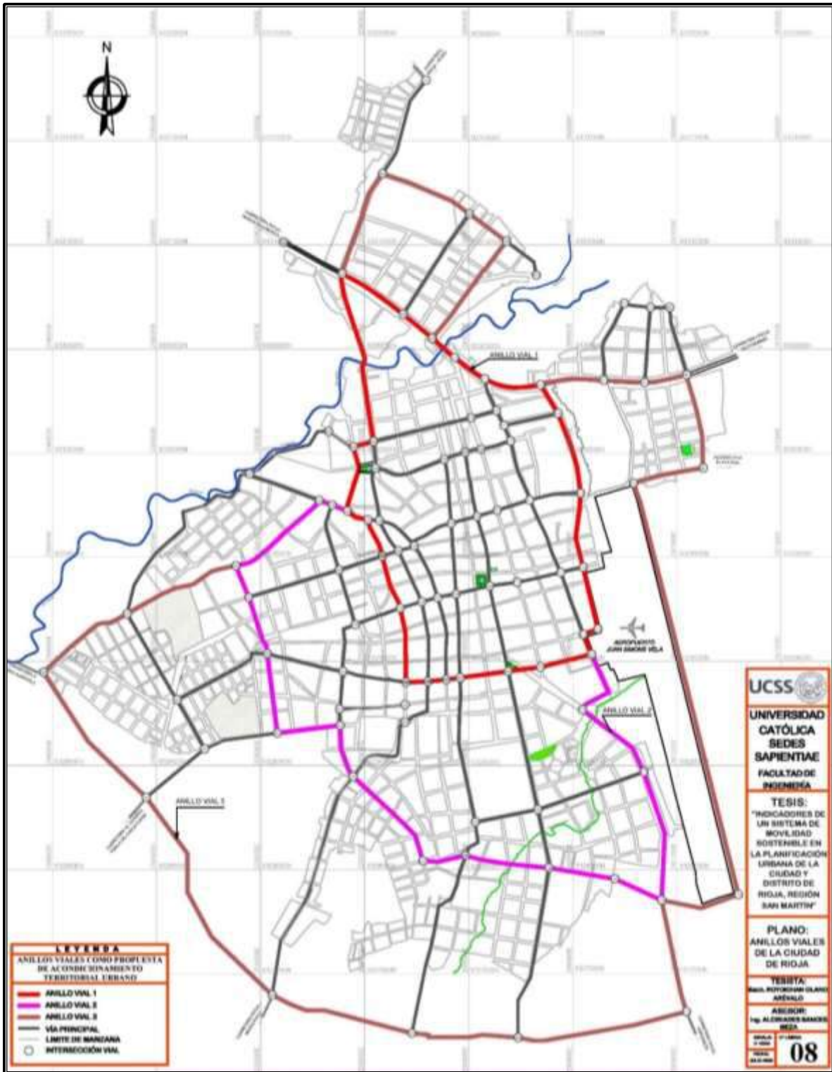
Figura 31. Plano de anillos viales como propuesta de acondicionamiento territorial urbano para la ciudad de Rioja.
