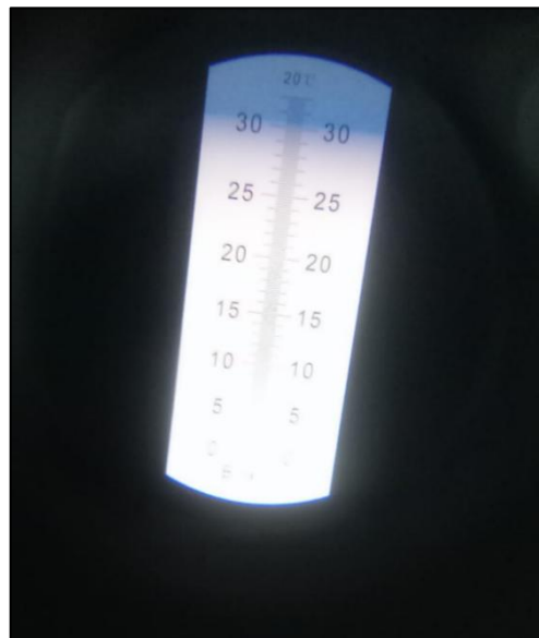
Medición de grados Brix del mosto
