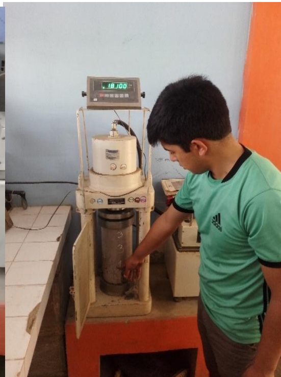
Imagen 45. Rotura de testigos – Cantera San Francisco
