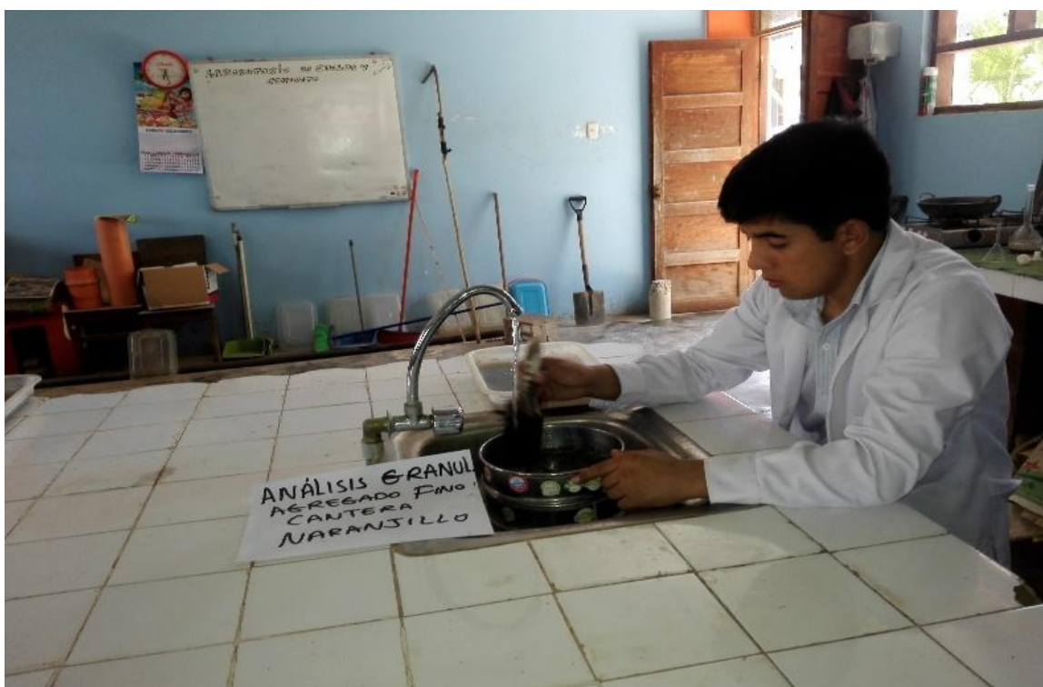
Imagen 10. Ensayo de cantidad de material que pasa por el tamiz N° 200 – Agregado fino
