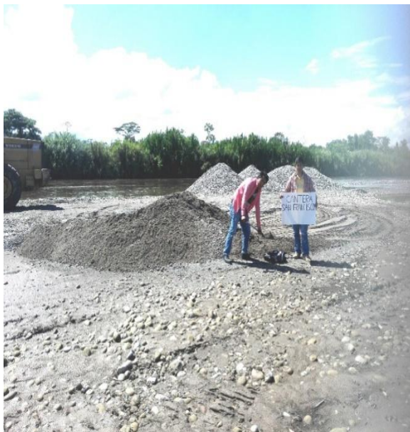
Imagen 6. Recolección y muestreo de los Agregados finos – Cantera San Francisco
