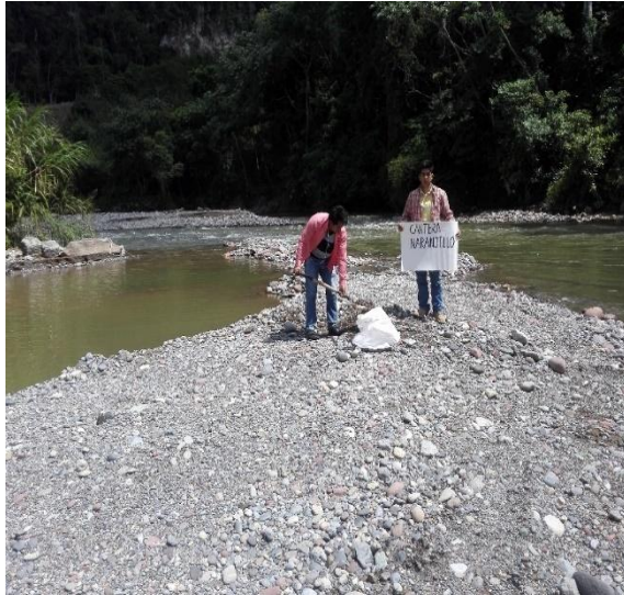
Imagen 4. Recolección y muestreo de los Agregados finos – Cantera Naranjillo
