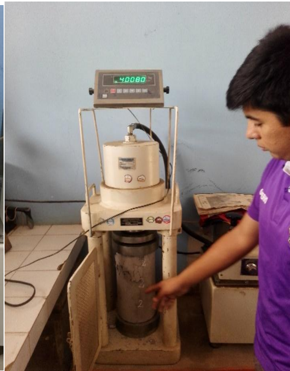
Imagen 43. Rotura de testigos – Cantera Naranjillo
