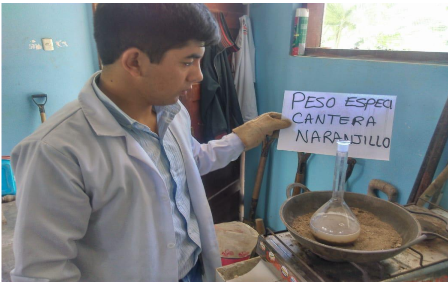
Imagen 18. Ensayo de peso específico de agregados finos M. fiola
