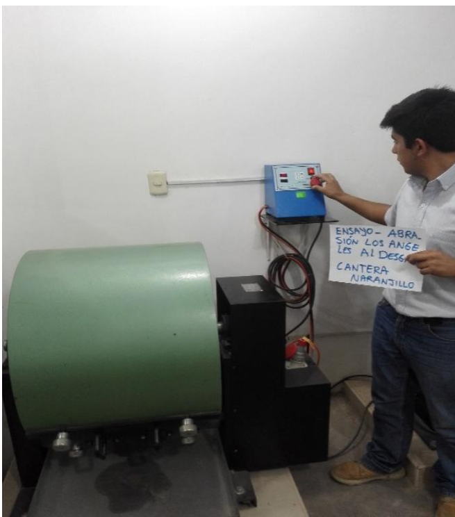
Imagen 20. Ensayo de Abrasión los Ángeles al desgaste – Cantera Naranjillo
