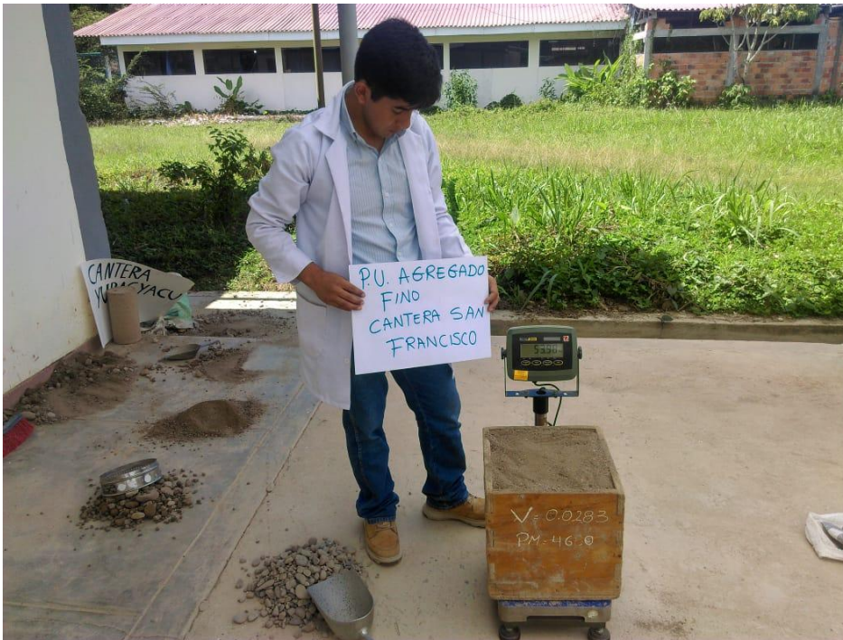
Imagen 13. Peso unitario agregado fino Cantera San Francisco
