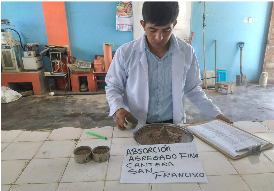
Imagen 16. Ensayo de absorción de la arena - Cantera San Francisco
