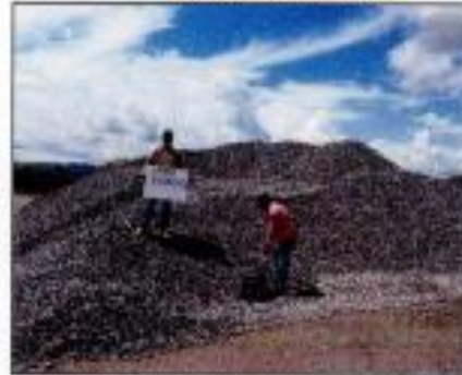
Foto 4. Recolección y muestreo de agregados gruesos cantera san francisco.
