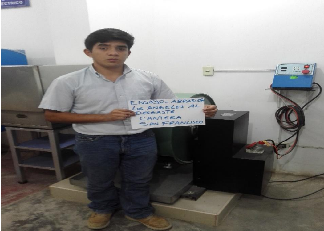
Imagen 21. Ensayo de Abrasión los Ángeles al desgaste – Cantera San Francisco
