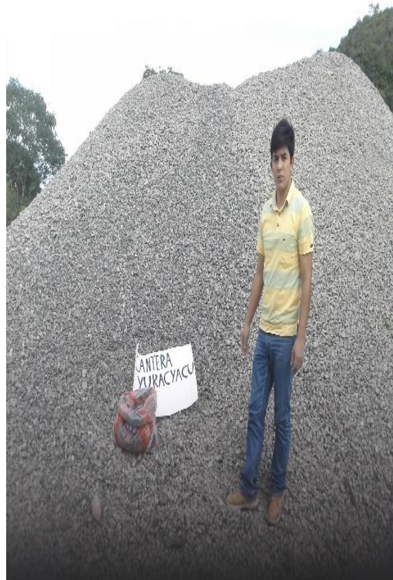
Imagen 9. Recolección y muestreo de los agregados gruesos - Cantera Yuracyacu
