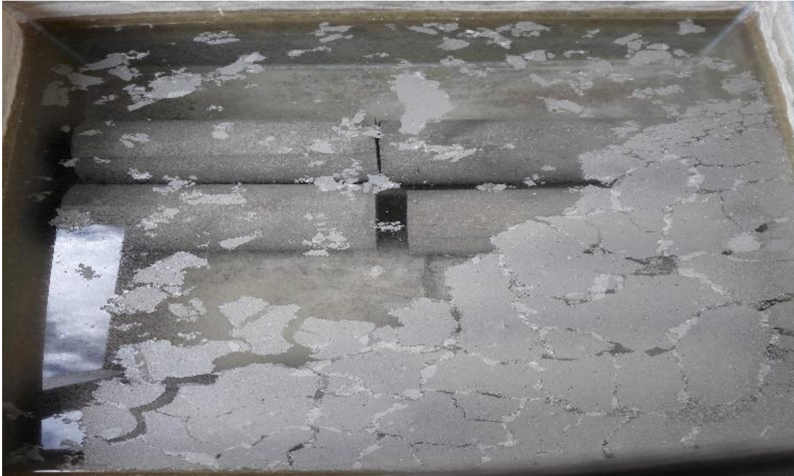
Imagen 29. Saturación de los testigos de concreto
