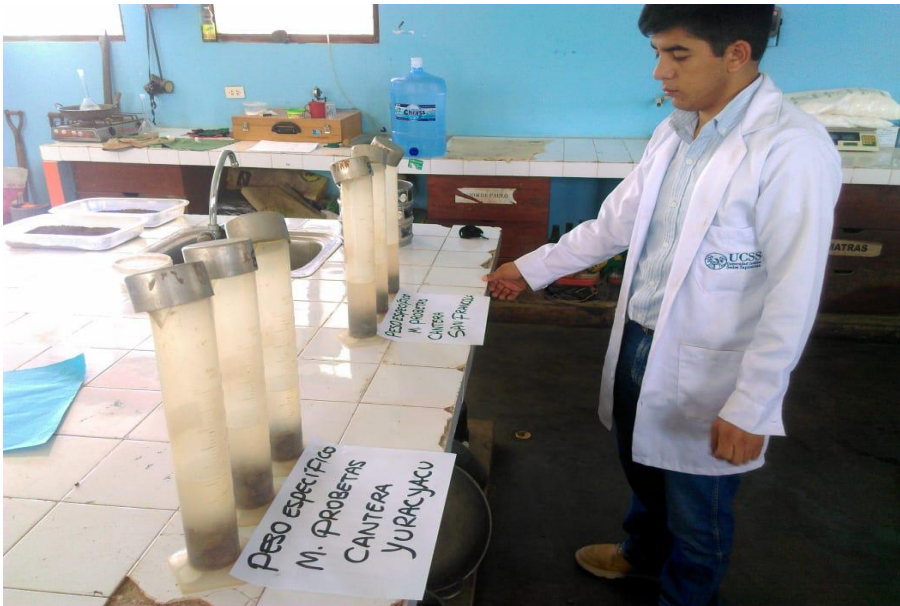
Imagen 19. Ensayo de peso específico agregados gruesos M. probetas
