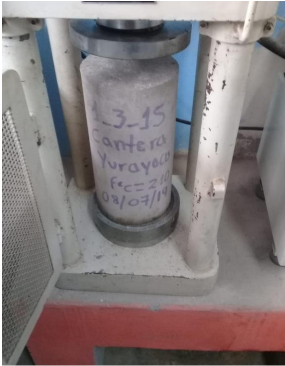
Imagen 40. Colocación de testigos – Cantera Yurayacu
