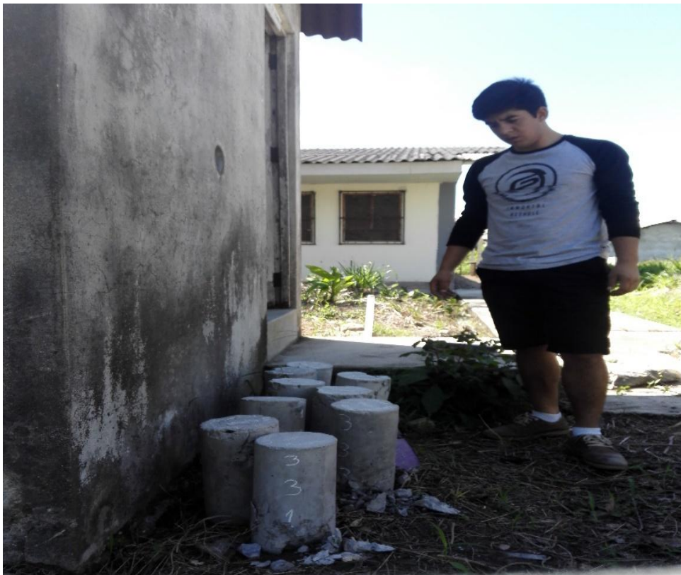
Imagen 46. Ensayo a compresión de nueve testigos sometidos a un diseño de f'c = 210 \text{ kg/cm}^2
