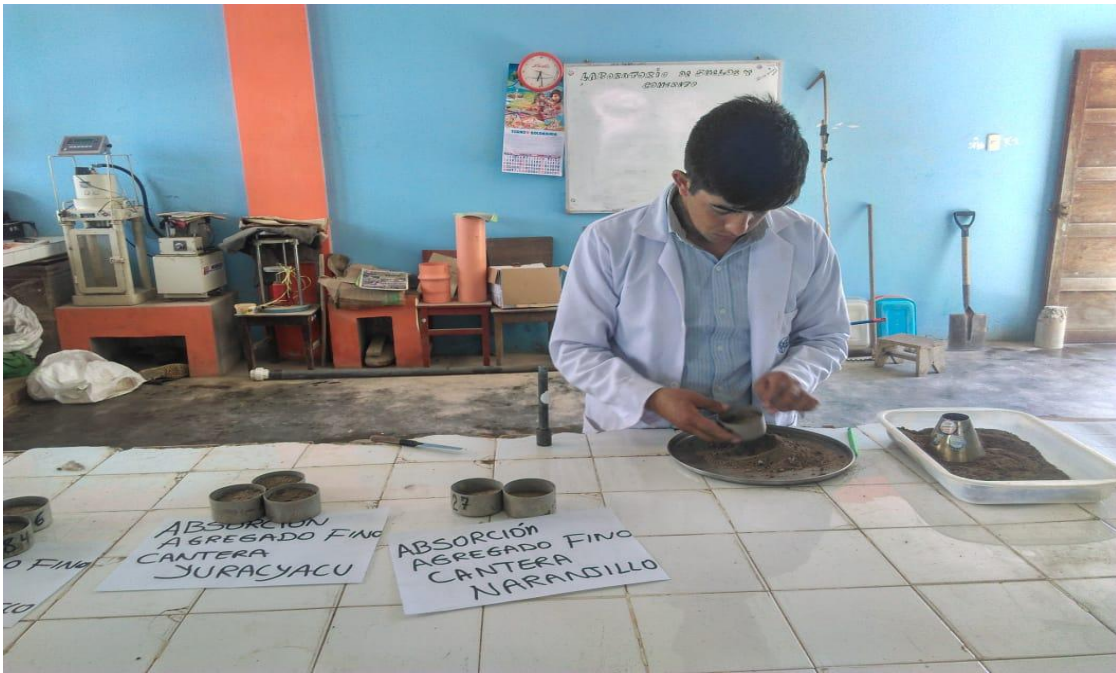
Imagen 15. Ensayo de absorción de la arena - Cantera Naranjillo
