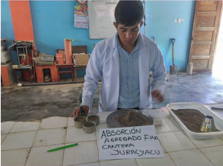
Imagen 17. Ensayo de absorción de la arena - Cantera Yuracyacu
