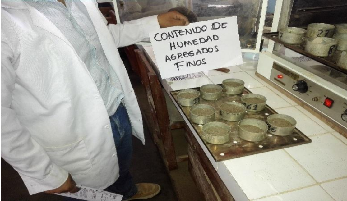
Imagen 23. Ensayo de humedad de agregados finos
