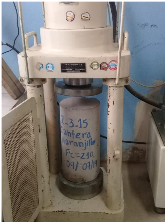
Imagen 42. Colocación de testigos – Cantera Naranjillo
