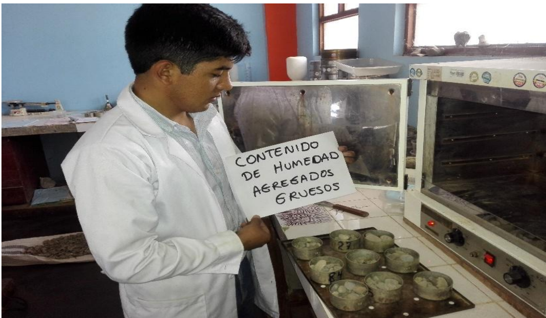
Imagen 24. Ensayo de humedad de agregados gruesos
