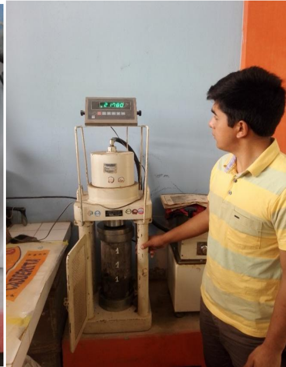
Imagen 41. Rotura de testigos – Cantera Yurayacu
