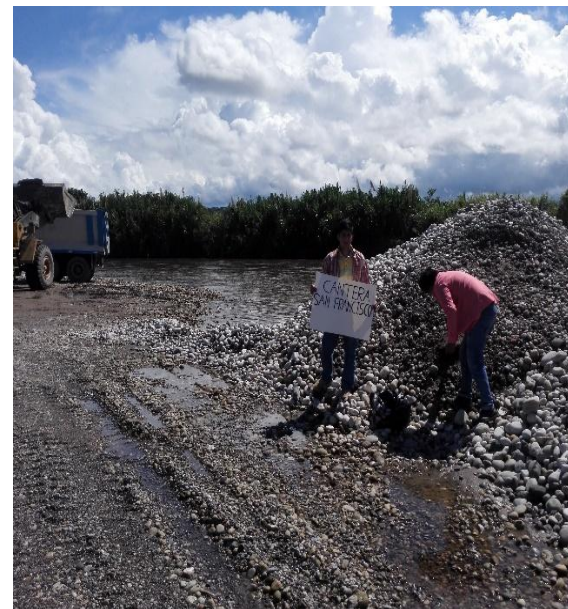
Imagen 7. Recolección y muestreo de los Agregados gruesos – Cantera San Francisco
