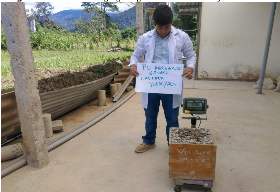
Imagen 12. Peso unitario agregado grueso - Cantera Yuracyacu
