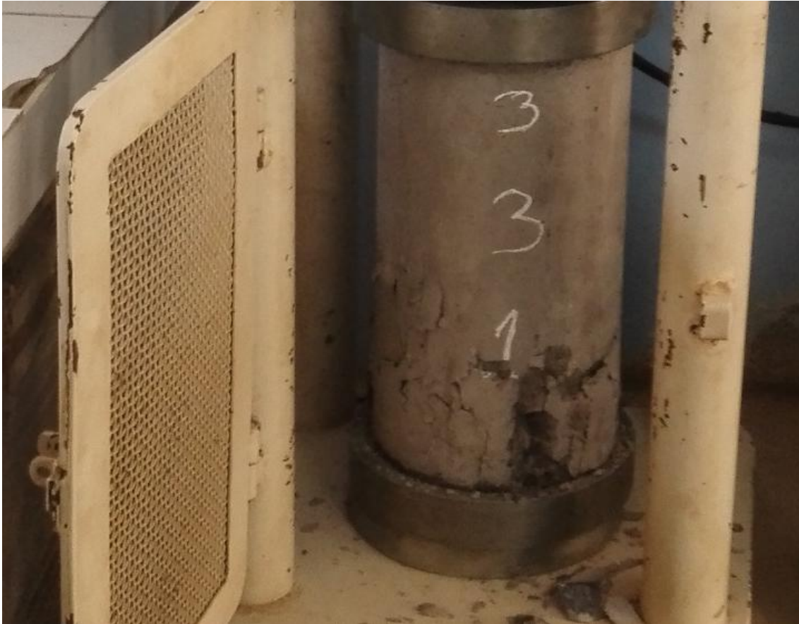
Imagen 31. Fallas a compresión testigos del concreto
