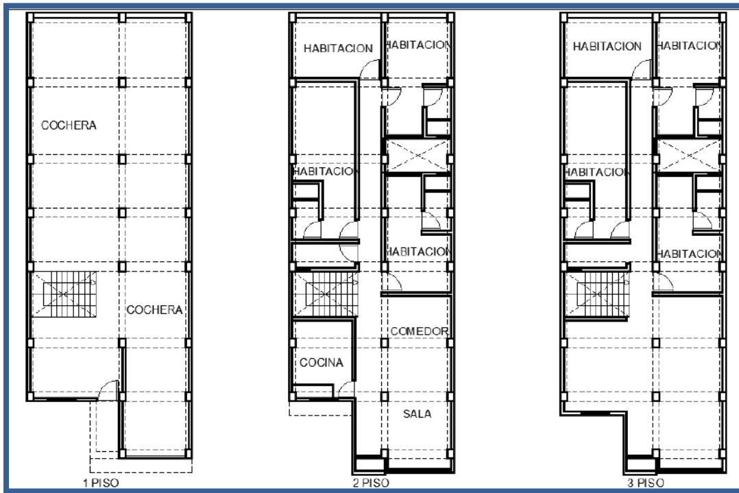
Figura 17. Viviendas de albañilería confinada rectangular de tres pisos Fuente: Propia
