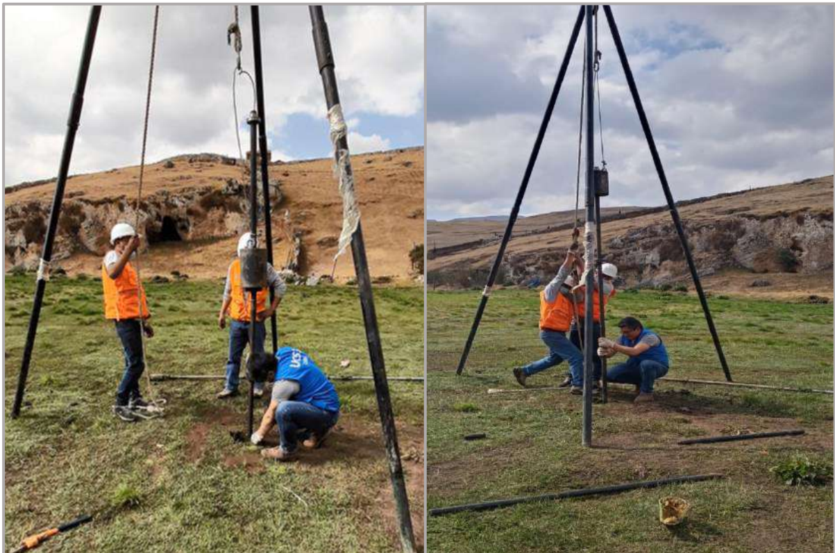
Figura 201. Hincado 02, con penetrómetro de 0.45 m. y pesa de 140 lb. ensayo SPT-01. Fuente: Elaboración Propia.
