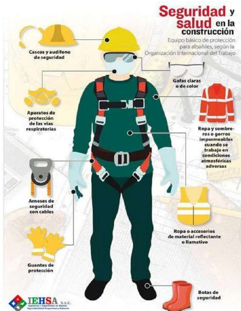
Figura 175. EPP's para personal obrero durante la construcción de PTAR. Fuente: Organización internacional del trabajo, adaptado por IEHSA S.A.C.
