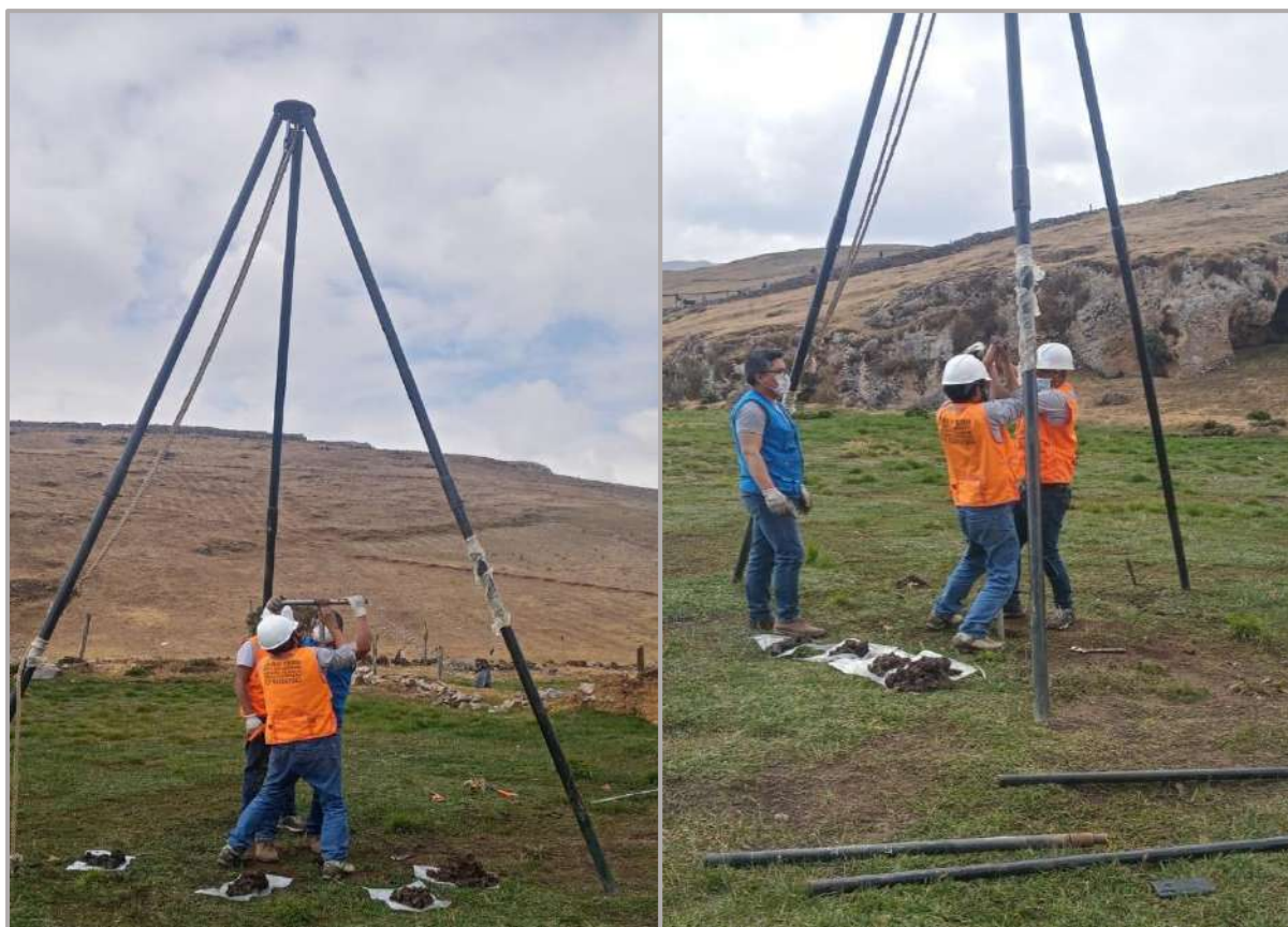
Figura 197. Sondeo con el barreno en espiral, profundidad 8.00 y 11.50 m, ensayo SPT-01 Fuente: Elaboración Propia.
