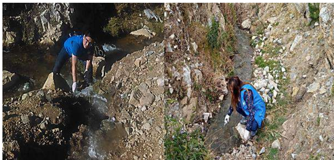
Figura 17. Toma de muestra de aguas residuales en punto de vertimiento.
