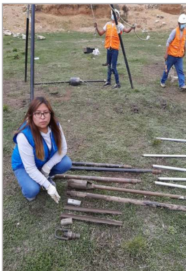
Figura 205. Equipos utilizados para la exploración de ensayo SPT-01. Fuente: Elaboración Propia.
