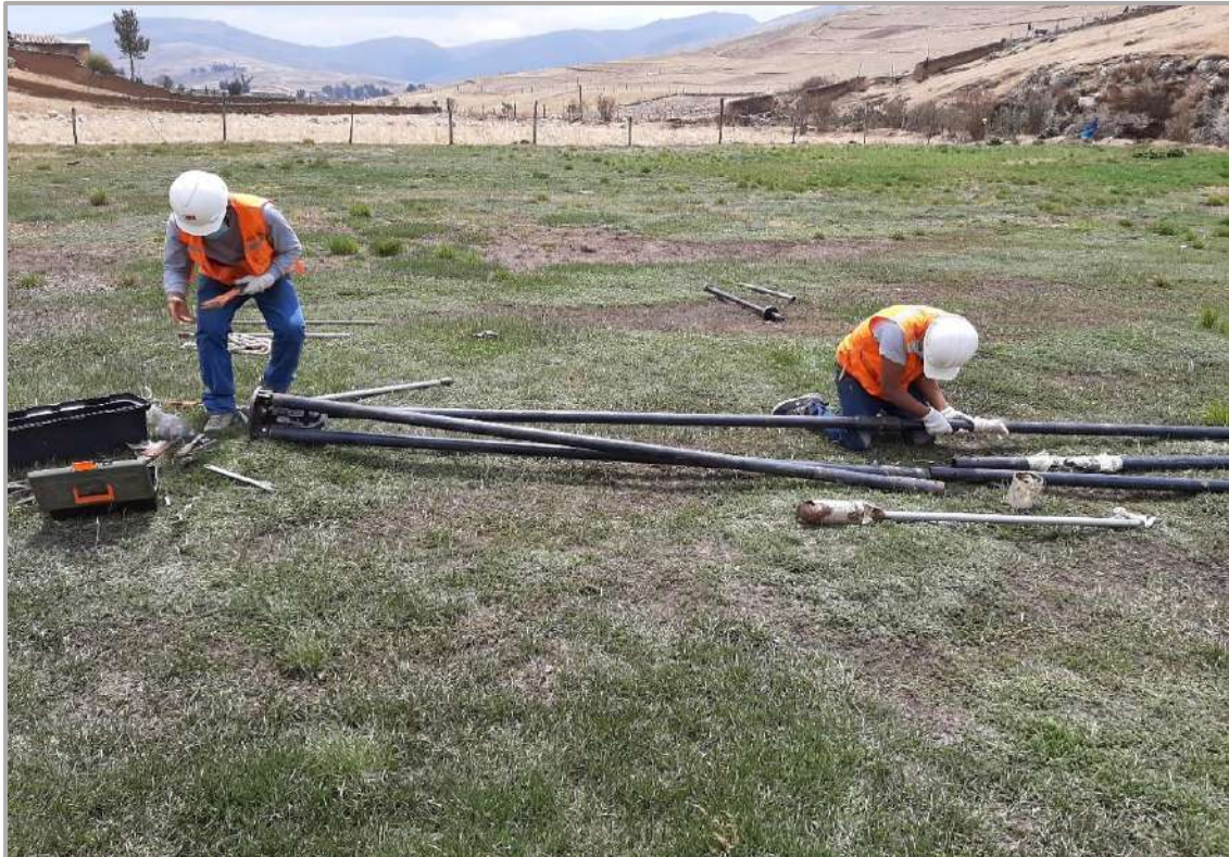
Figura 192. Armado de trípode para realizar ensayo SPT-01. Fuente: Elaboración Propia.
