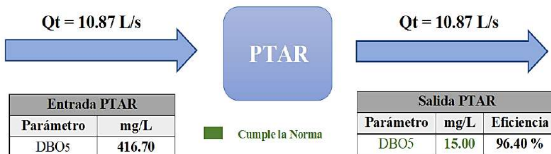
Figura 174. Balance de cargas de DBO 5 al ingreso y salida de la PTAR.
