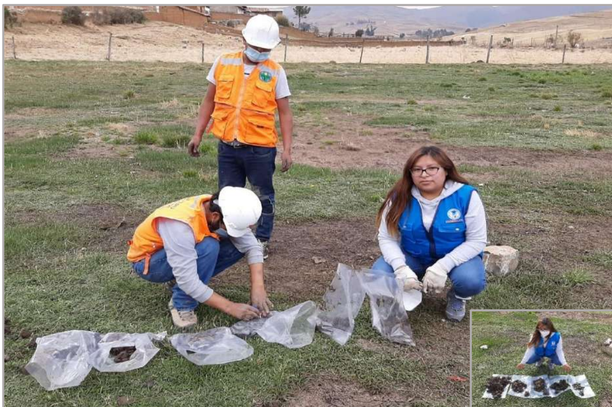
Figura 204. Rotulado de muestras previo a su traslado a laboratorio “Chuqui Perú, ensayo SPT-01. Fuente: Elaboración Propia.
