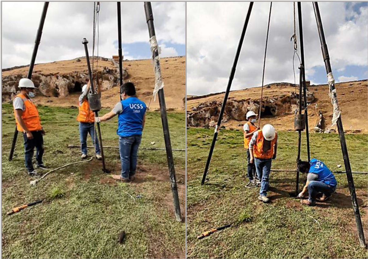
Figura 200. Hincado 01, con penetrómetro de 0.45 m. y pesa de 140 lb. ensayo SPT-01. Fuente: Elaboración Propia.
