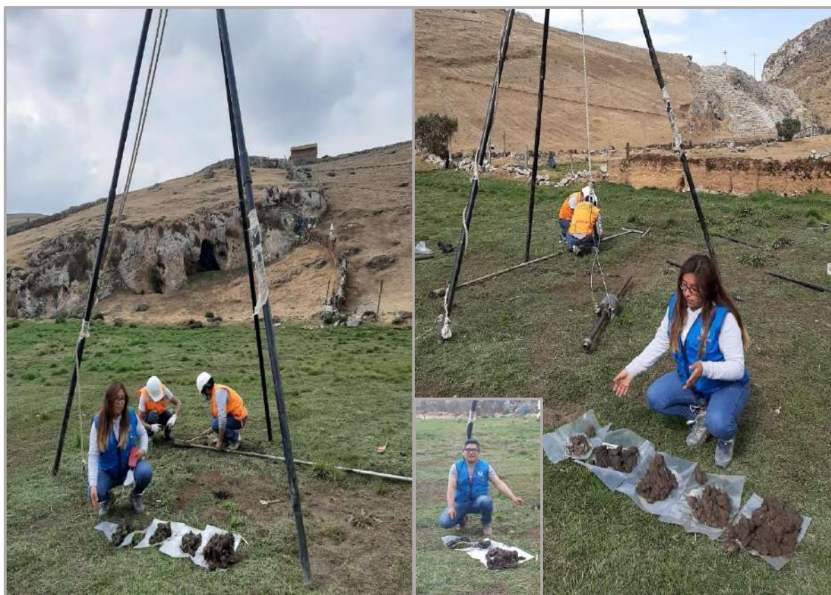
Figura 198. Recuperación de muestras del ensayo SPT-01. Fuente: Elaboración Propia.
