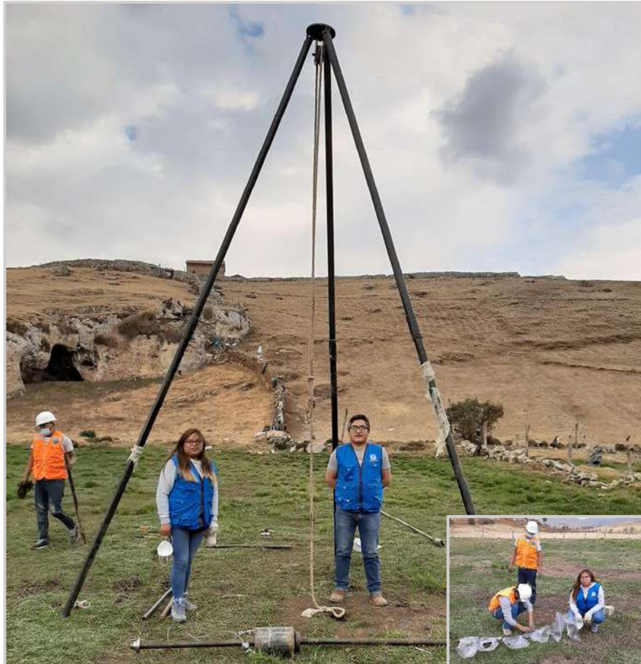
Figura 21. Ensayo de penetración estándar SPT-01. Fuente: Elaboración Propia.
