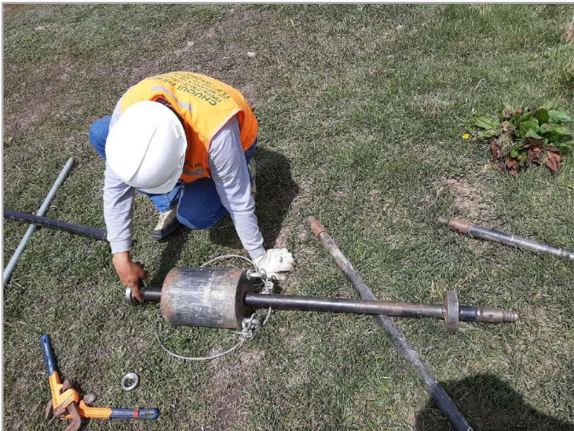
Figura 195. Armado e inspección de pesa 140 lb, ensayo SPT-01. Fuente: Elaboración Propia.
