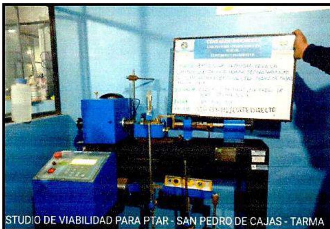
FOTOGRAFÍA N°13: Vista del ensayo de corte directo de la muestra proporcionada por el peticionario, realizado en los ambientes de laboratorio de suelos CENTAURO INGENIEROS, provincia de Huancayo, Departamento de Junín, para el proyecto: "ESTUDIO DE VIABILIDAD PARA LA CONSTRUCCION DE UNA PLANTA DE TRATAMIENTO DE AGUAS RESIDUALES (PTAR), EN SAN PEDRO DE CAJAS – TARMA - JUNIN". Fotografía remitida por el personal de laboratorio.
