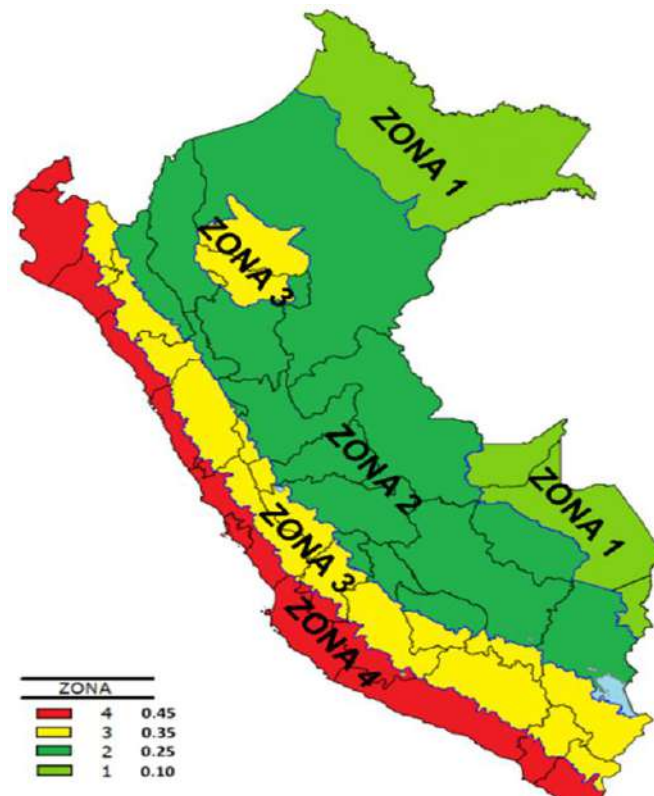
Figura 136. Factores de zona “Z”, Norma E-030, diseño sismorresistente Fuente: Tabla 4 – Norma E-020.
