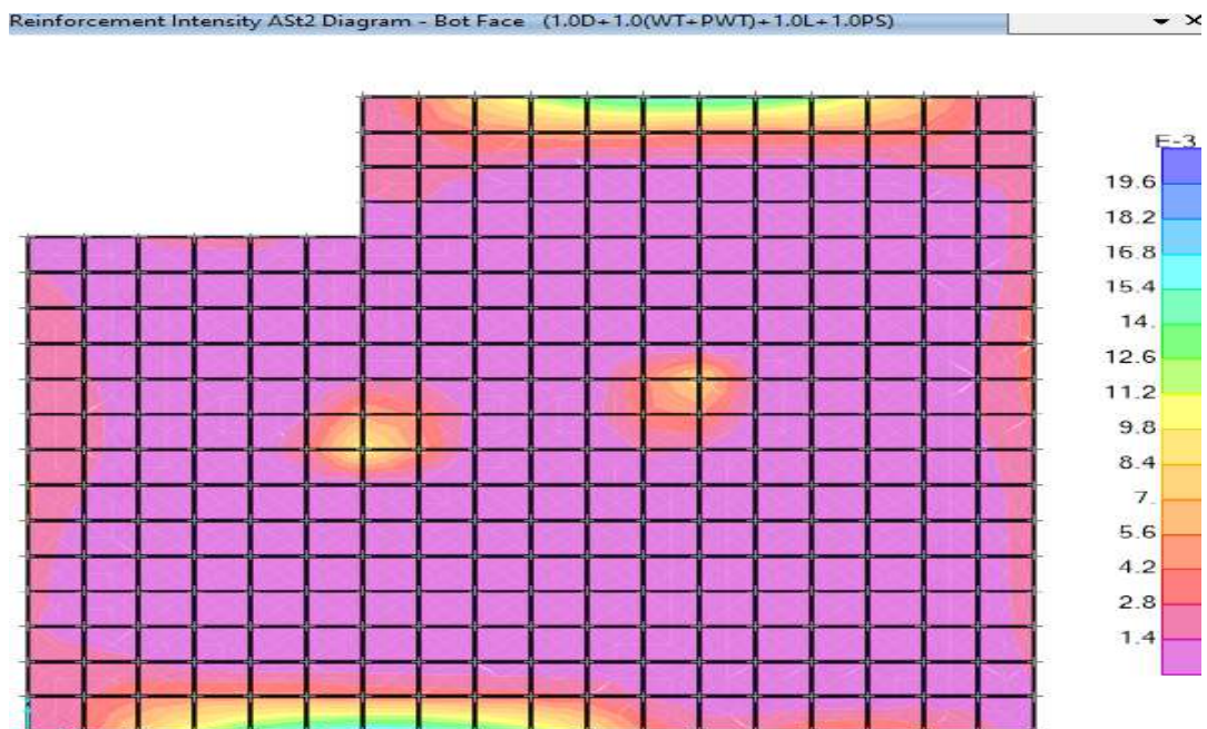
Figura 167. Diagrama de reforzamiento de acero en cara inferior– D2, platea c.contacto. Fuente: Elaboración Propia.
