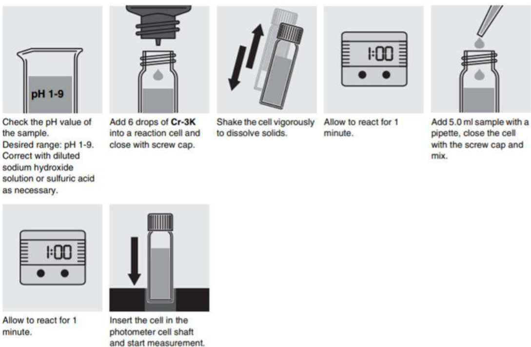
Figura 16. Manual uso para determinar el Cromo. Fuente: Xylem Analytics Germany GmbH (2010) Photometry Analysis Manual ba75509e15 pFotoFlex® Turb.
