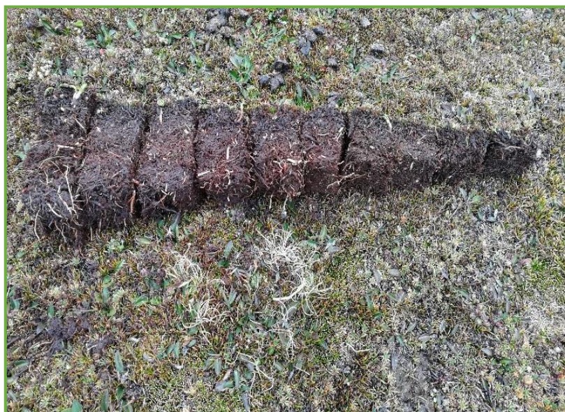
Figura 9. Diez (10) submuestras de 4 x 4 x 1 cm; 4 x 4 x 2 cm; 4 x 4 x 3 cm; 4 x 4 x 4 cm; 4 x 4 x 5 cm; 4 x 4 x 6 cm; 4 x 4 x 7 cm; 4 x 4 x 8 cm; 4 x 4 x 9 cm; y 4 x 4 x 10 cm. Fuente: Elaboración propia.
