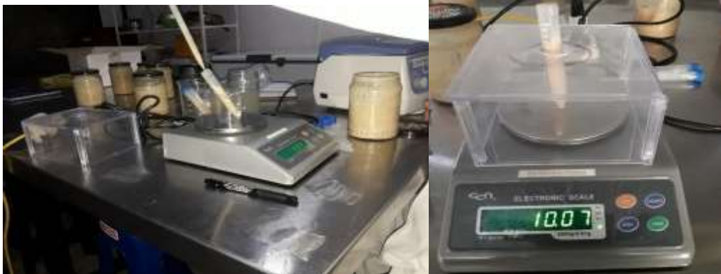
Medición de la sinéresis y % de retención de agua del yogur tipo batido.
