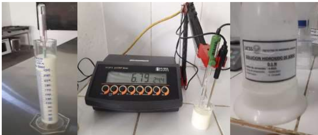
Realización de análisis de calidad a la leche fresca: Densidad, pH y acidez titulable
