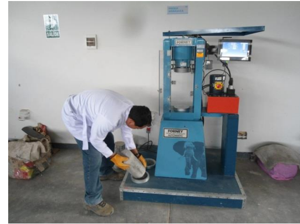
Foto 21. Colocación de los Testigos en la Prensa Hidráulica
