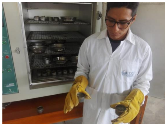
Foto 6. Ensayo de Humedad de los Agregados
