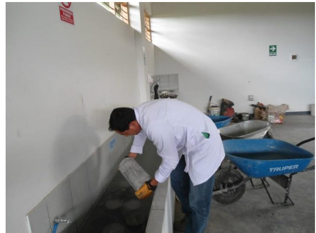
Foto 18. Saturación de los Testigos de Concreto
