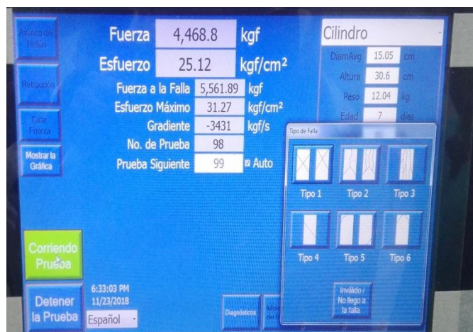
Foto 19. Fallas a la Compresión de los testigos de concreto
