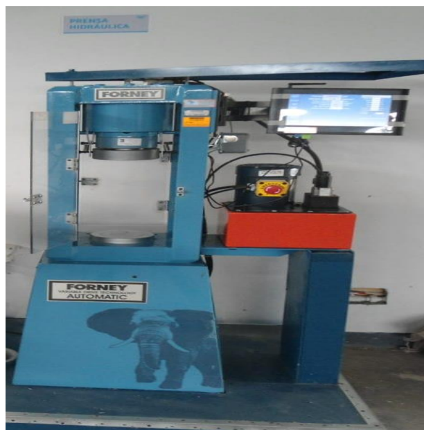
Foto 16. Prensa Hidráulica para Pruebas de Compresión
