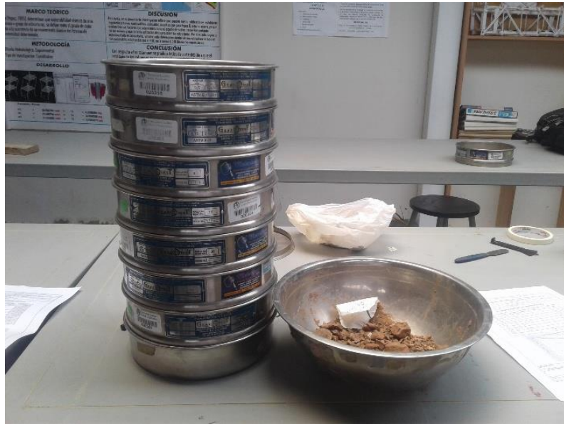
Figura 64. Muestra a tamizar (Fuente; Propia, fotografía de la muestra a tamizar)
