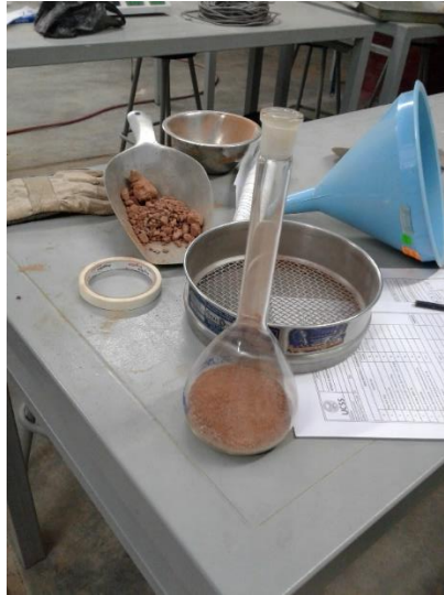
Figura 84. Muestra seca dentro de la fiola (Fuente; Propia, fotografía de la muestra seca dentro de la fiola)
