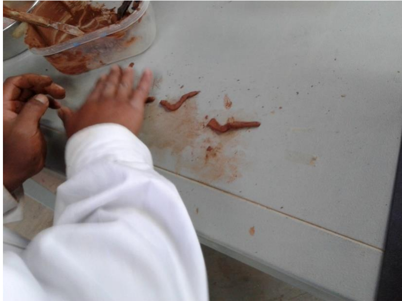
Figura 79. Enrollado de la muestra (Fuente; Propia, fotografía del ensayo del límite plástico)
