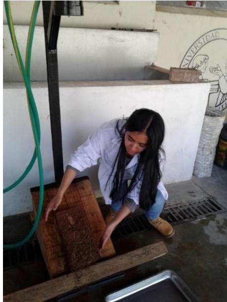
Figura 101. Retiro del testigo de adobe del Equipo de Erosión Acelerada (Fuente; Propia, fotografía del retiro del testigo de adobe del equipo)
