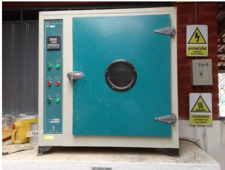
Figura 62. Secado de la muestra en el horno (Fuente; Propia, fotografía de la muestra que tiene que secar en el horno a una temperatura de 110 \pm 5 °C)
