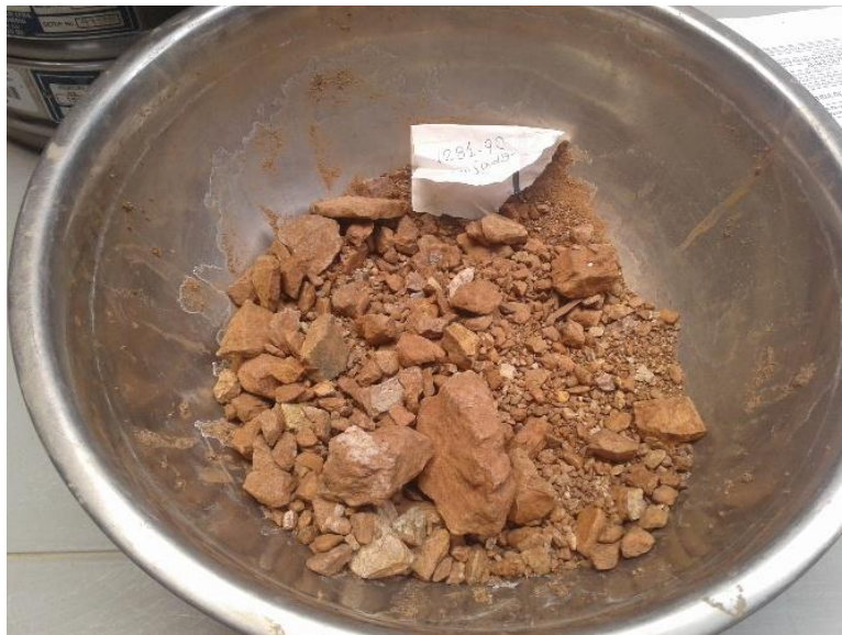
Figura 63. Muestra seca (Fuente; Propia, fotografía de la muestra secada en el horno a una temperatura de 110 \pm 5 °C)
