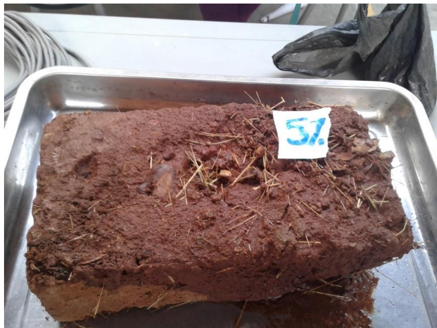
Figura 116. Bloque de adobe con 5% de savia (Fuente; Propia, fotografía de la erosión que se produjo en el adobe con 5% de savia de nopal)
