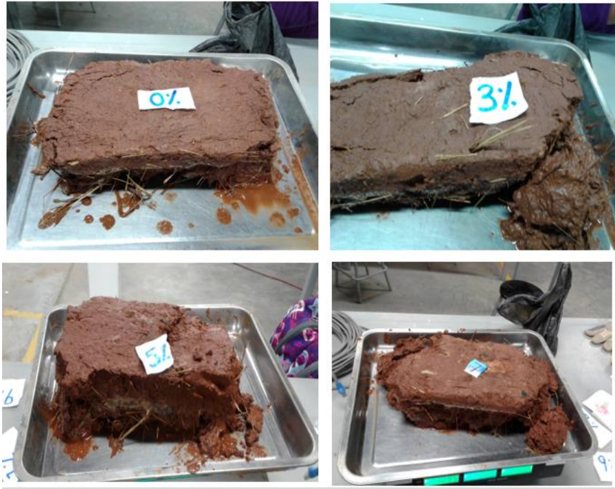
Figura 109. Ensayo de absorción en bloques de adobes con 0%, 3%, 5%, 7% y 9% de savia de nopal (Fuente; Propia, fotografía del ensayo de absorción en adobes)
