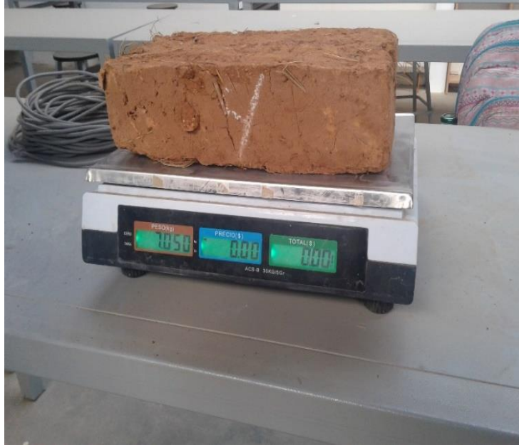
Figura 86. Pesos secos de los testigos de adobes (Fuente; Propia, fotografía del peso seco del adobe con la inserción de 9% de savia de nopal)
