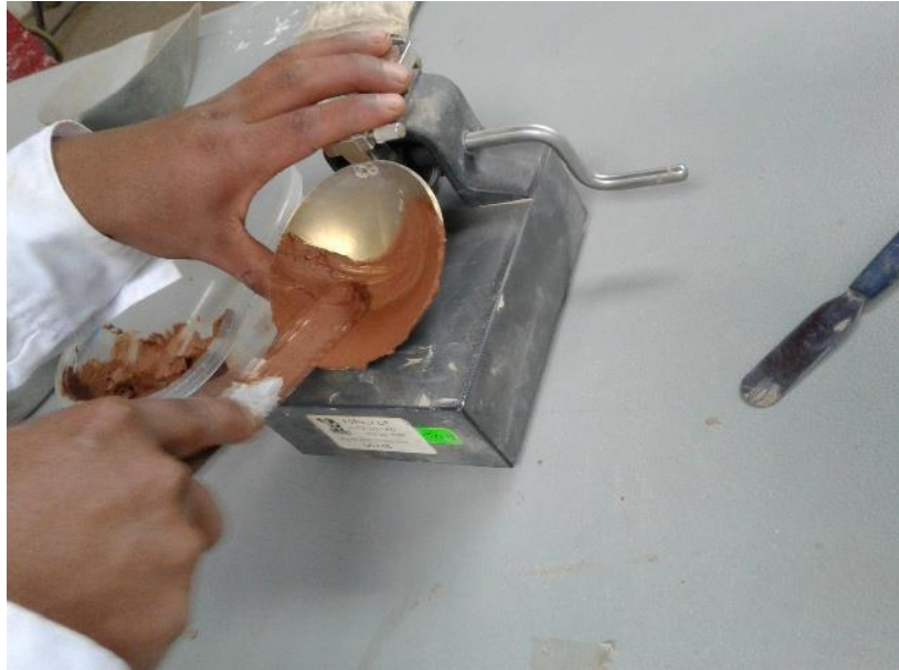
Figura 76. Colocación de la mezcla en la cazuela Casagrande (Fuente; Propia, fotografía de la muestra colocada en la cazuela Casagrande)
