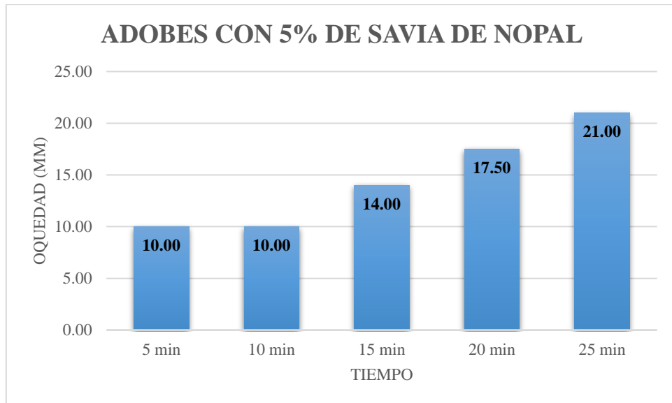
Figura 115. Resultados para adobes con 5% de savia de nopal (Fuente; Elaboración Propia)
