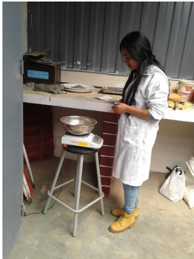
Figura 83. Peso de la muestra húmeda (Fuente; Propia, fotografía de la muestra húmeda)
