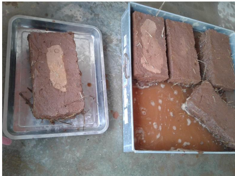
Figura 95. Retiro de los testigos de la bandeja con agua (Fuente; Propia, fotografía del retiro de los testigos de la bandeja)
