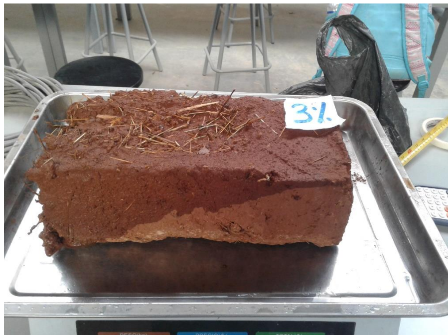
Figura 114. Bloque de adobe con 3% de savia (Fuente; Propia, fotografía de la erosión que se produjo en el adobe con 3% de savia de nopal)
