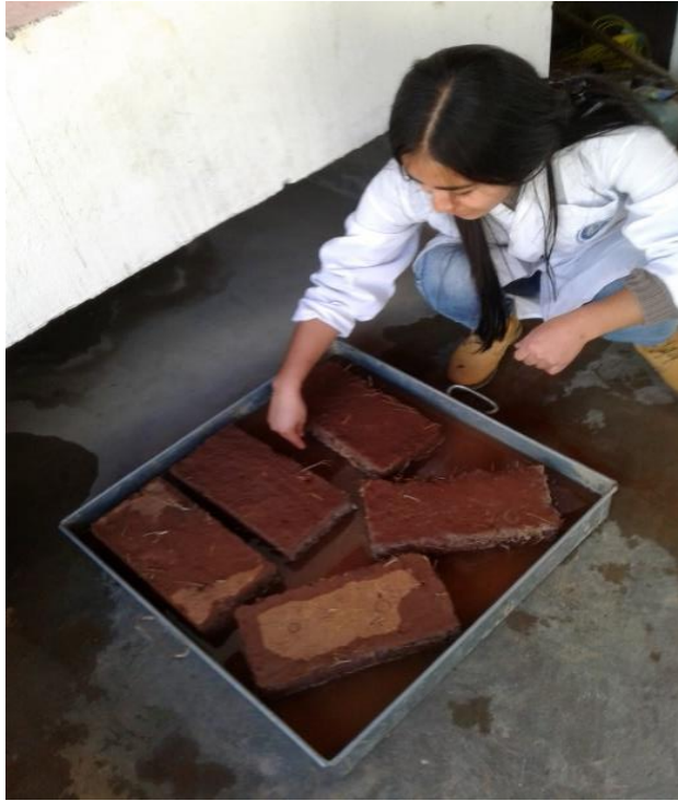
Figura 94. Retirado de los testigos de adobes de la bandeja con agua (Fuente; Propia, fotografía del retiro de los testigos de la bandeja)
