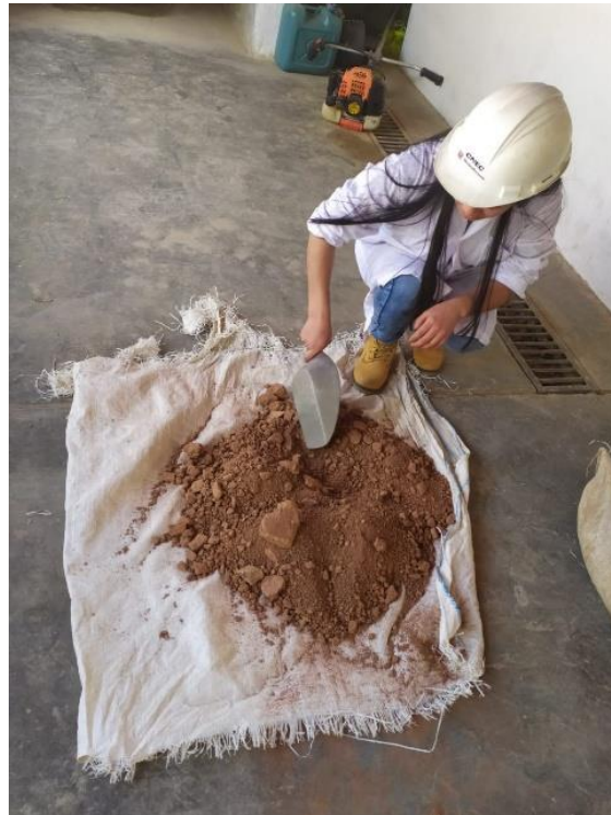
Figura 58. Cuarteo de la tierra a utilizar (Fuente; Propia, fotografía del cuarteo de la muestra en el laboratorio)
