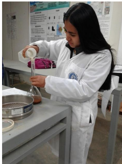
Figura 85. Ensayo de Peso específico del suelo (Fuente; Propia, fotografía de la muestra seca dentro de la fiola)
