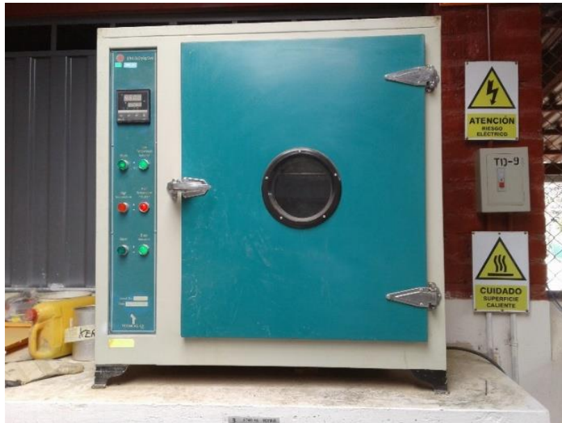
Figura 69. Secado de la muestra en el horno (Fuente; Propia, fotografía del peso de la muestra)
