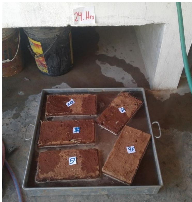
Figura 93. Sumersión de los testigos por un periodo de 24 horas (Fuente; Propia, fotografía de los testigos sumergidos en agua por 24 horas)
