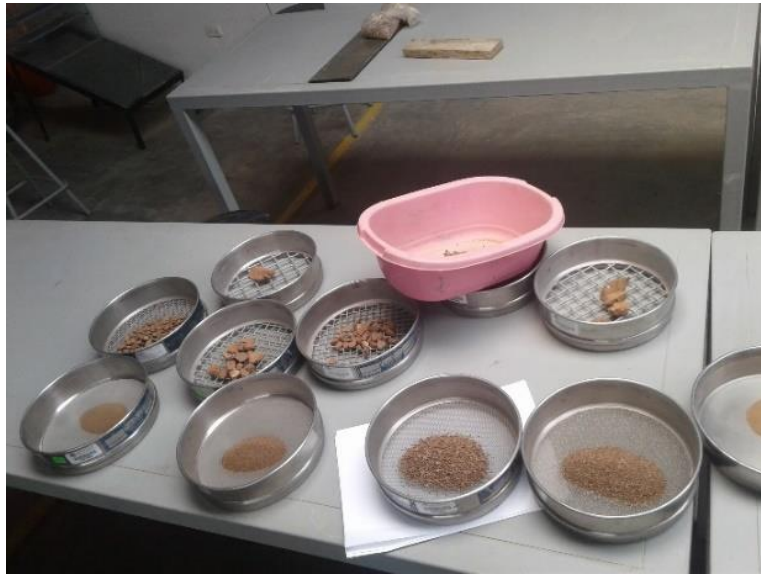
Figura 66. Muestra de cada material retenido en las diferentes mallas (Fuente: Propia, fotografía del tamizado de la muestra)
