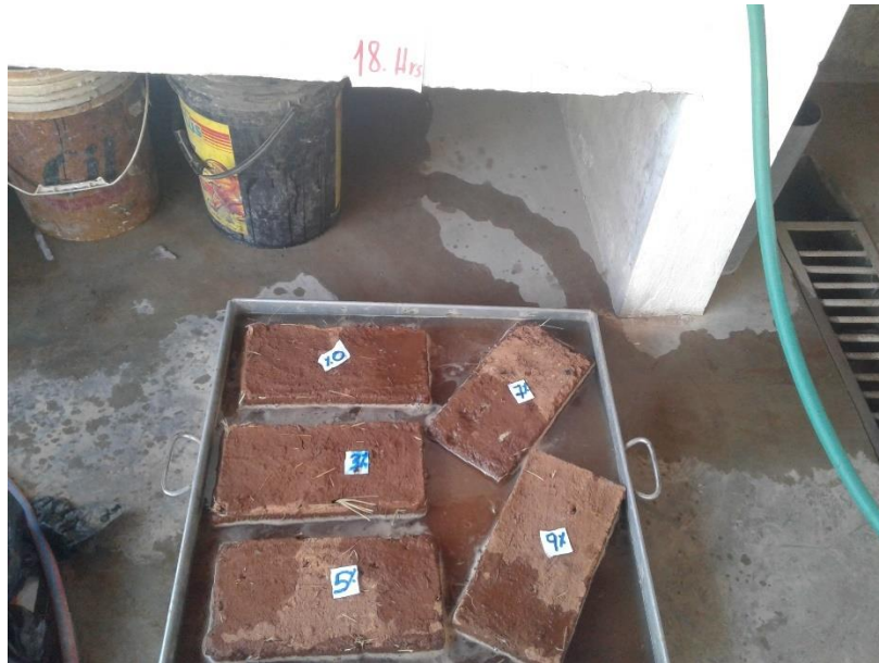
Figura 92. Sumersión de los testigos por un periodo de 18 horas (Fuente; Propia, fotografía de los testigos sumergidos en agua por 18 horas)
