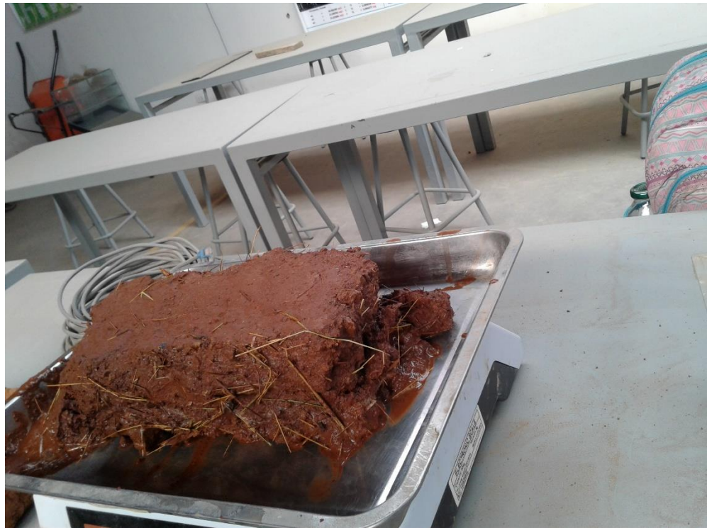
Figura 108. Bloque de adobe con mayor porcentaje de absorción (Fuente; Propia, fotografía del ensayo de absorción en adobes)
