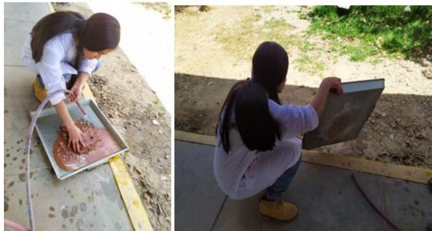
Figura 59. Lavado de la muestra (Fuente; Propia, fotografía del lavado de la muestra de la tierra a utilizar)
