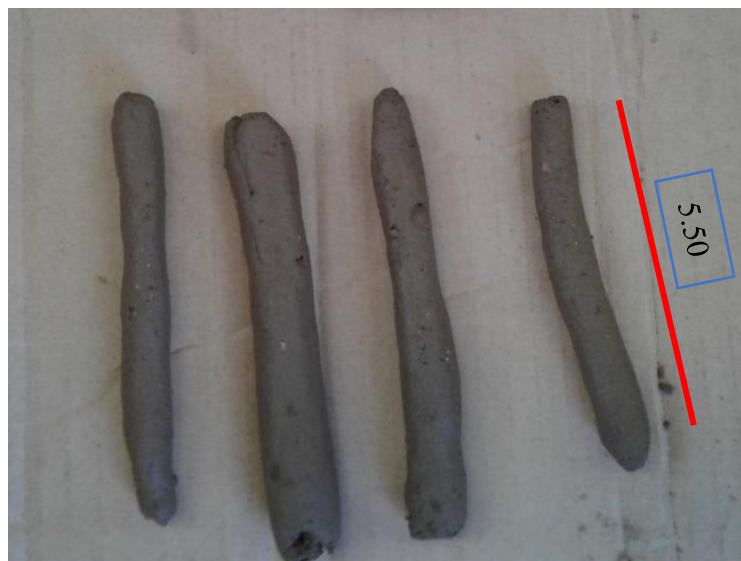
Figura 38. Prueba de plasticidad (prueba del rollo) (Fuente; Propia, fotografía de la prueba del rollo que se realizó)
