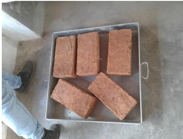
Figura 87. Colocación de los testigos de adobes en la bandeja (Fuente; Propia, fotografía de los testigos antes de ser sumergidas)
