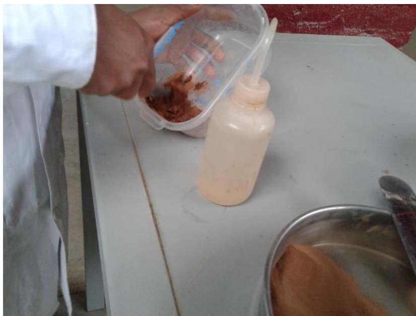
Figura 75. Mezcla de la muestra fina con agua (Fuente; Propia, fotografía de la mezcla)
