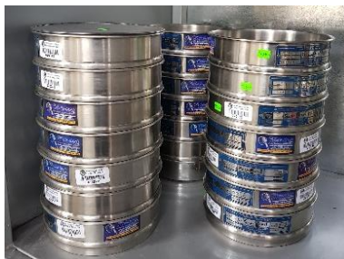
Figura 57. Muestra de los tamices de zarandeo (Fuente; Propia, fotografía de los tamices de zarandeo)
