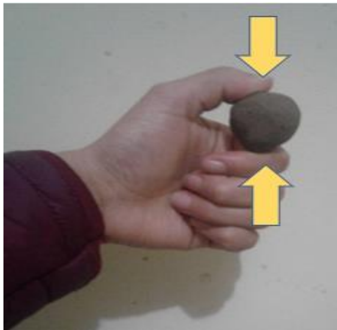
Figura 40. Prueba de campo de la resistencia de la bolita seca (Fuente; Propia, fotografía de la prueba de la bolita seca que se realizó)
