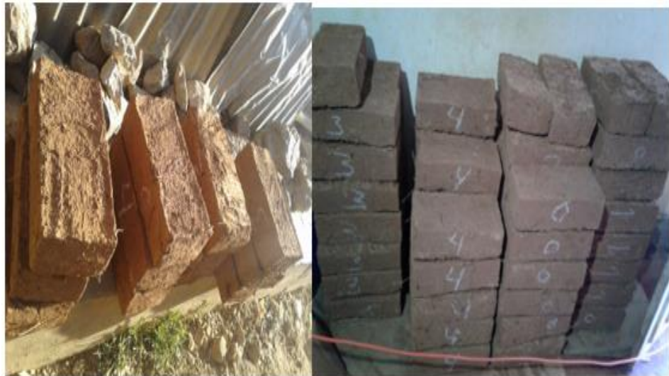
Figura 54. Tendido y secado de los adobes (Fuente; Propia, fotografía de las unidades de adobes ya secas)
