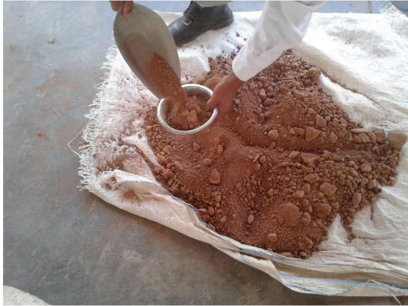
Figura 82. Toma de 500 g de tierra como muestra (Fuente; Propia, fotografía de la muestra húmeda)
