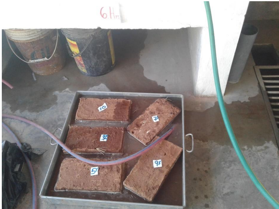
Figura 90. Sumersión de los testigos por un periodo de 6 horas (Fuente; Propia, fotografía de los testigos sumergidos en agua por 6 horas)
