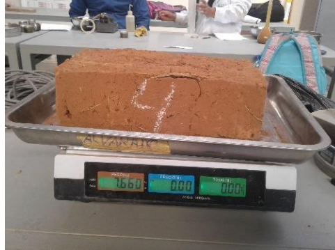
Figura 99. Pesos secos de los testigos (Fuente; Propia, fotografía del peso seco del adobe con la inserción de 9% de savia de nopal)
