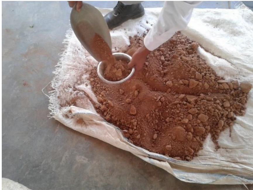
Figura 67. Cuarteo de la muestra (Fuente; Propia, fotografía del cuarteo de la muestra)
