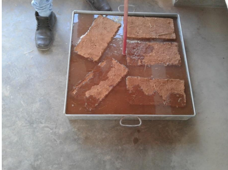
Figura 88. Adobes sumergidos en agua (Fuente; Propia, fotografía de los testigos sumergidos en agua)
