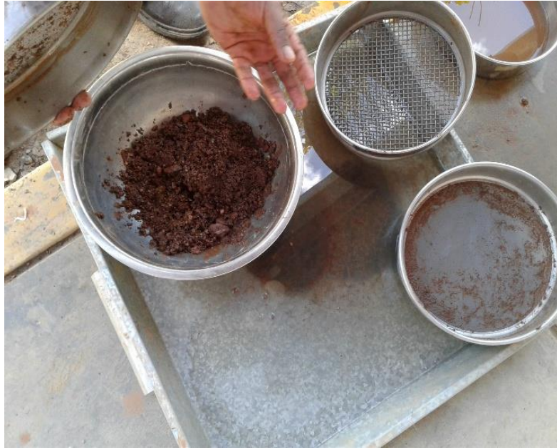
Figura 60. Lavado de la muestra (Fuente; Propia, fotografía del lavado de la muestra a tamizar)
