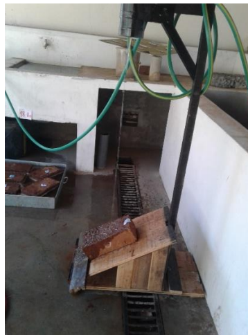
Figura 100. Ensayo de Erosión Acelerada en adobes (Fuente; Propia, fotografía del Ensayo de Erosión Acelerada)
