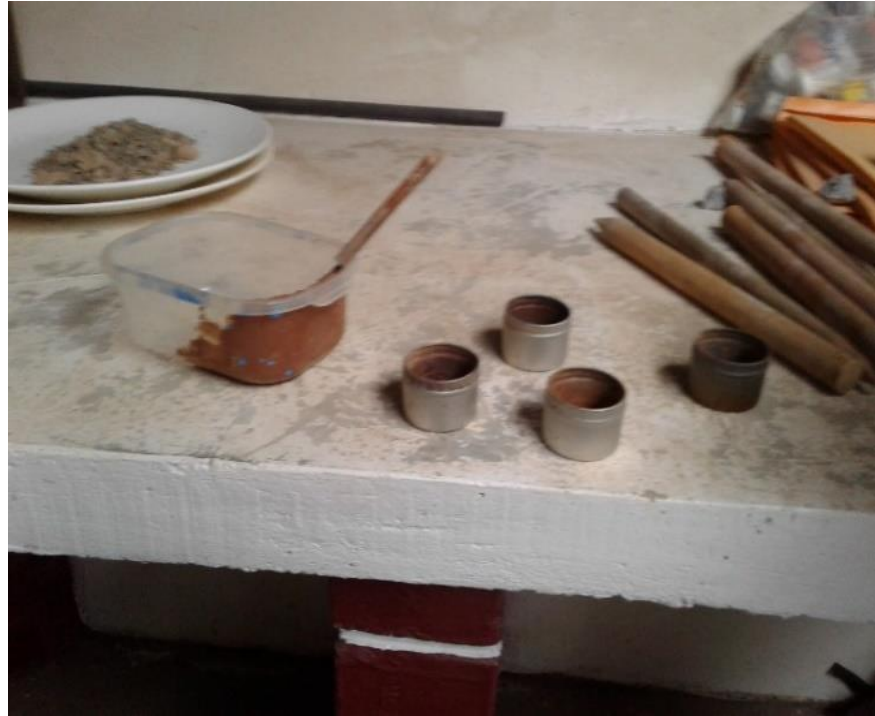
Figura 78. Muestras del ensayo de límite líquido (Fuente; Propia, fotografía de las muestras del ensayo de límite líquido)
