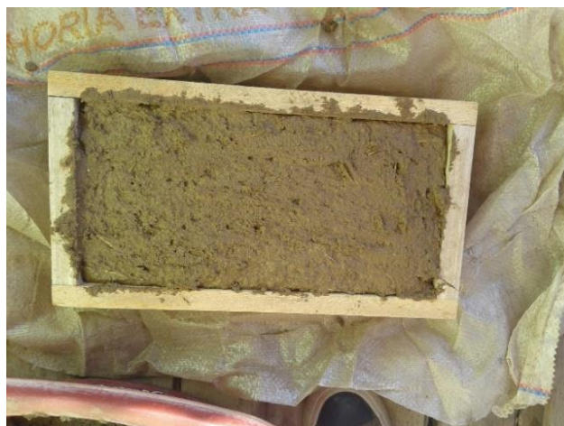
Figura 15. Dimensiones de la adobera 30x15x10 (Fuente; Propia, fotografía de la adobera llena con la mezcla)
