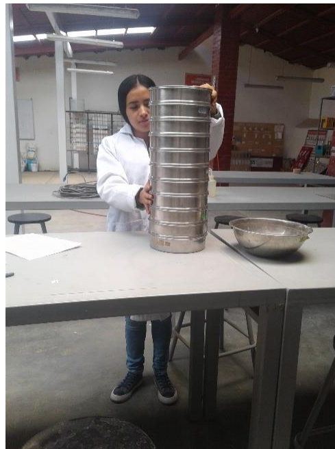
Figura 65. Tamizado de la muestra (Fuente; Propia, fotografía del tamizado de la muestra)
