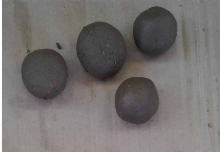
Figura 39. Prueba de resistencia (prueba de la bolita seca) (Fuente; Propia, fotografía de la prueba de la bolita seca que se realizó)
