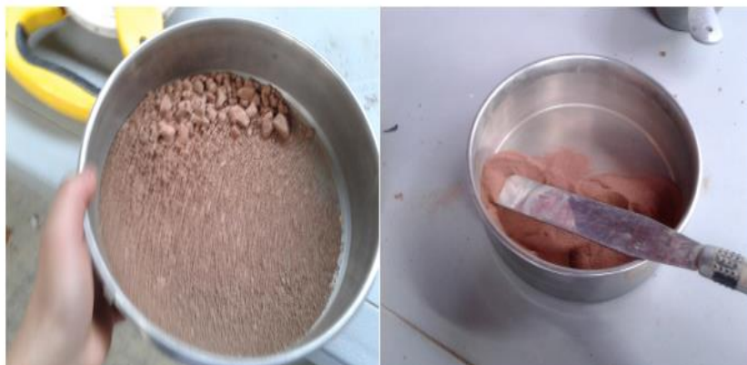
Figura 74. Muestra tamizada en la malla N°40 (Fuente; Propia, fotografía de la muestra que pasa la malla N°40)
