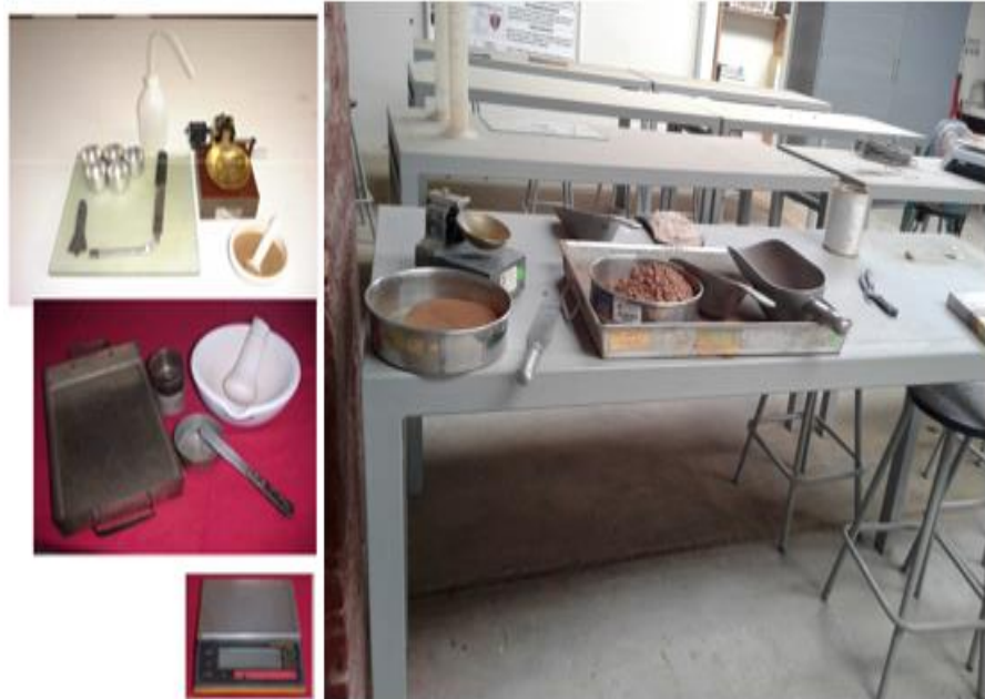
Figura 72. Materiales para realizar el ensayo del límite líquido (Fuente; Recuperado del manual de ensayos de laboratorio de suelos I de la Universidad Católica Sedes Sapientiae)
