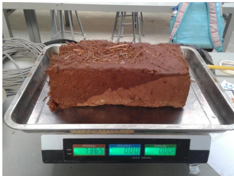
Figura 112. Bloque de adobe con 0% de savia (Fuente; Propia, fotografía de la erosión que se produjo en el adobe con 0% de savia de nopal)
