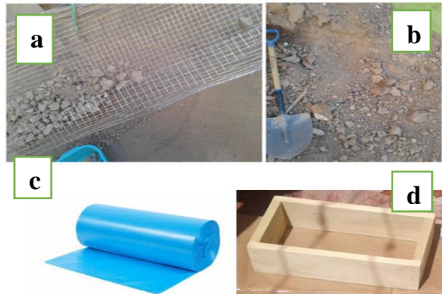
Figura 7. Herramientas para elaborar adobes, a) Zaranda, b) Lampa, c) Plástico, d) Adobera (Fuente; Propia, fotografía de las herramientas)
