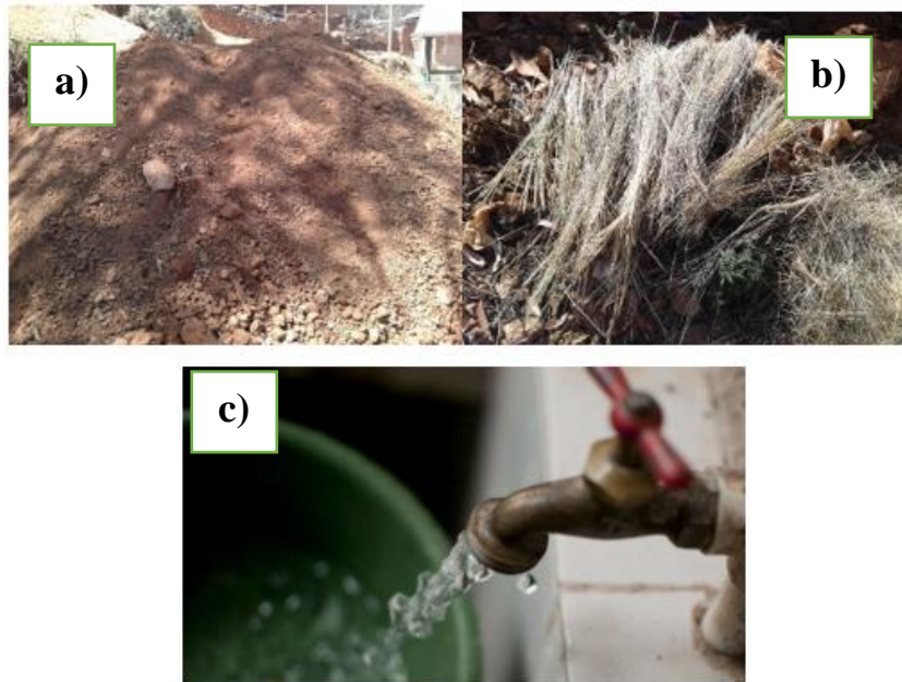
Figura 6. Materiales para elaborar adobes a) tierra, b) paja, c) agua (Fuente; Propia, fotografía de los materiales para su elaboración)
