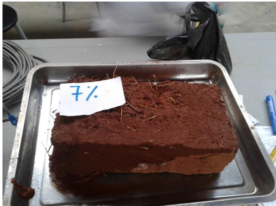
Figura 118. Bloque de adobe con 7% de savia (Fuente; Propia, fotografía de la erosión que se produjo en el adobe con 7% de savia de nopal)
