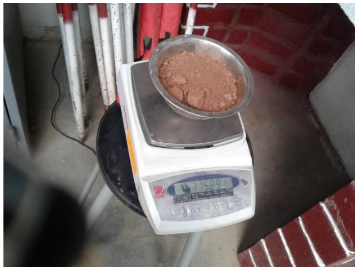
Figura 70. Peso de la muestra seca (Fuente; Propia, fotografía del peso de la muestra seca)
