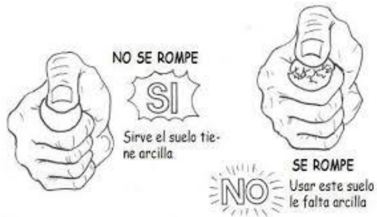
Figura 12. Prueba de resistencia (prueba de la bolita seca) (Fuente; Imagen recopilada del Manual para la construcción de viviendas de adobe 1993)
