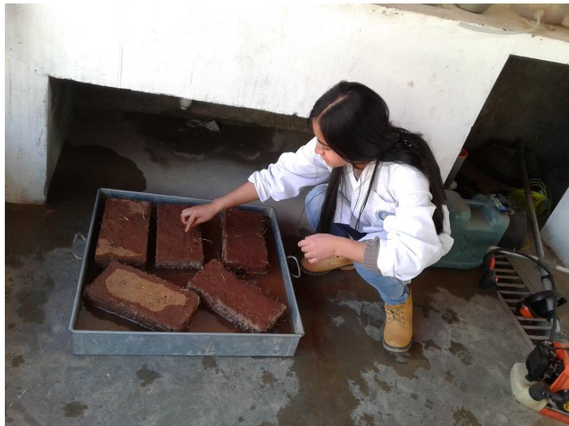
Figura 89. Sumergiendo los adobes en agua (Fuente; Propia, fotografía de los testigos sumergidos en agua)
