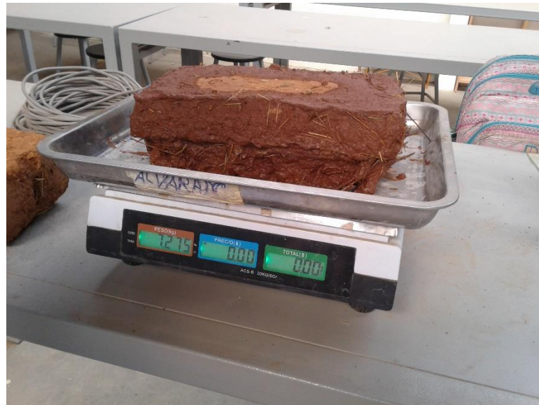
Figura 96. Peso del testigo saturado en agua (Fuente; Propia, fotografía del peso saturado en agua del testigo de adobe)
