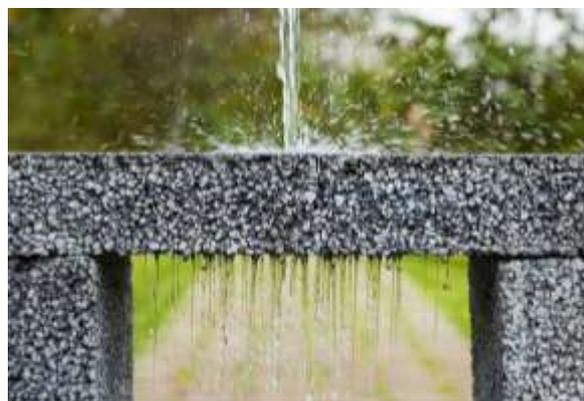
Figura 4 Permeabilidad del concreto absorbente
