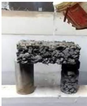
Figura 36 Ensayo de permeabilidad en el espécimen de prueba
