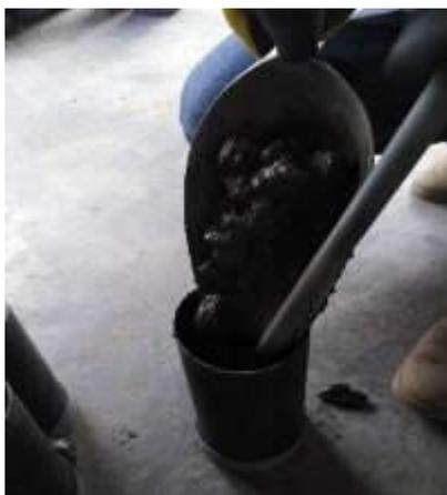
*Figura 31* Proceso de llenado del concreto en los moldes
