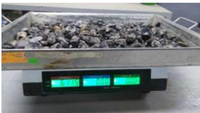
*Figura 19* Muestra para hallar contenido de humedad del agregado grueso
