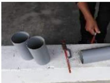
Figura 26 Moldes cilíndricos de 10x20.5 cm para realizar ensayo de rotura de probetas
