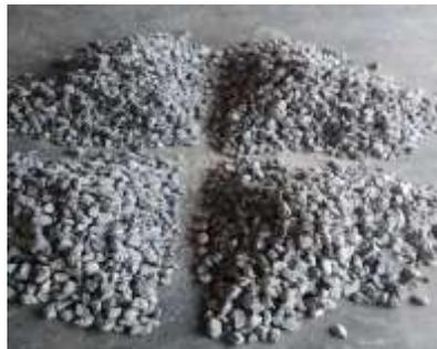
*Figura 14* Cuarteo de material para realizar ensayo de peso específico y porcentaje de absorción del agregado
