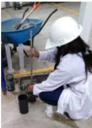
*Figura 33* Proceso de compactación de las probetas para resistencia a compresión
