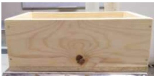
Figura 27 Moldes rectangulares de 20x30x10 cm para realizar ensayo de permeabilidad del concreto absorbente
