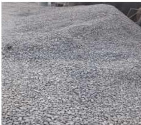
*Figura 8* Agregado grueso de 3/4 " para realizar las pruebas requeridas
