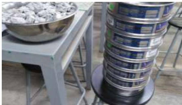
Figura 12 Tamices normalizados para realizar granulometría de agregado grueso
