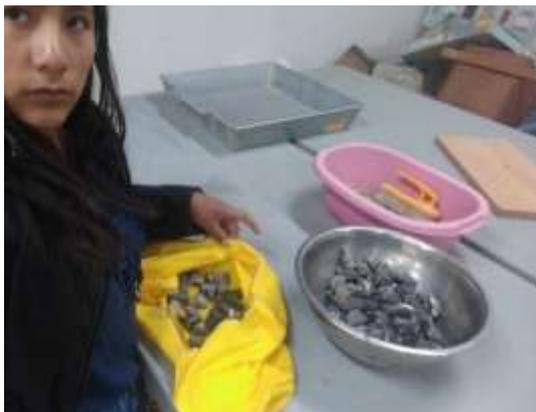
*Figura 16* Proceso de secado superficialmente del agregado de muestra para el ensayo de peso específico y porcentaje de absorción
