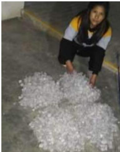
*Figura 10* Proceso de cuarteo del agregado grueso
