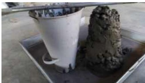
*Figura 22* Revenimiento 0" para concretos permeables
