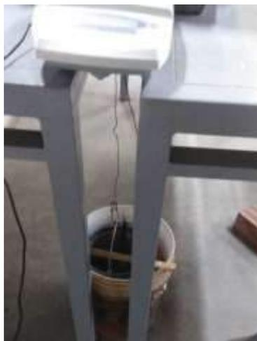
Figura 18 Muestra del agregado grueso insertado al agua
