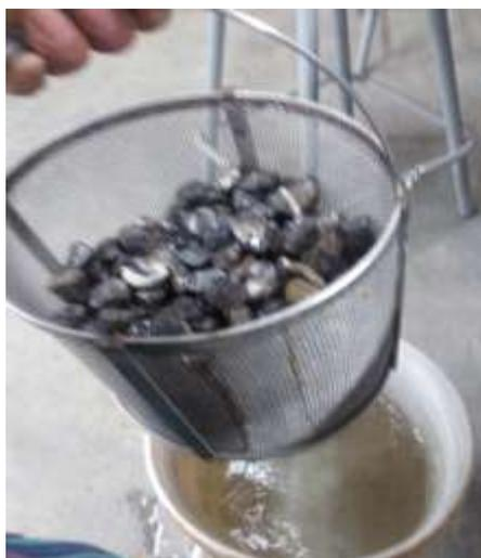
*Figura 17* Muestra del agregado grueso antes de insertarlo al agua
