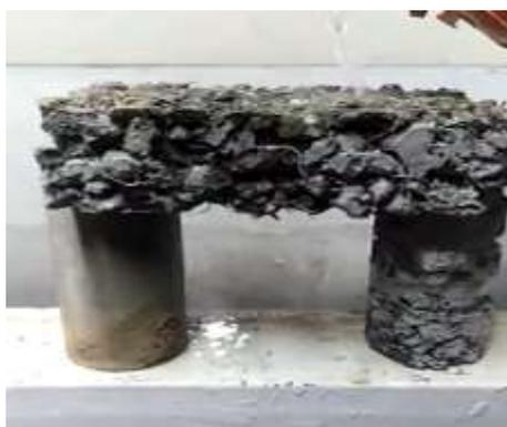
Figura 24 Realización de prueba de permeabilidad del concreto absorbente
