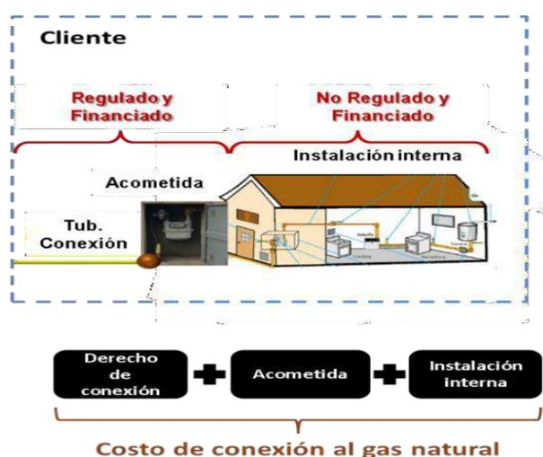
Figura 6. Componentes de la conexión de gas natural residencial.
