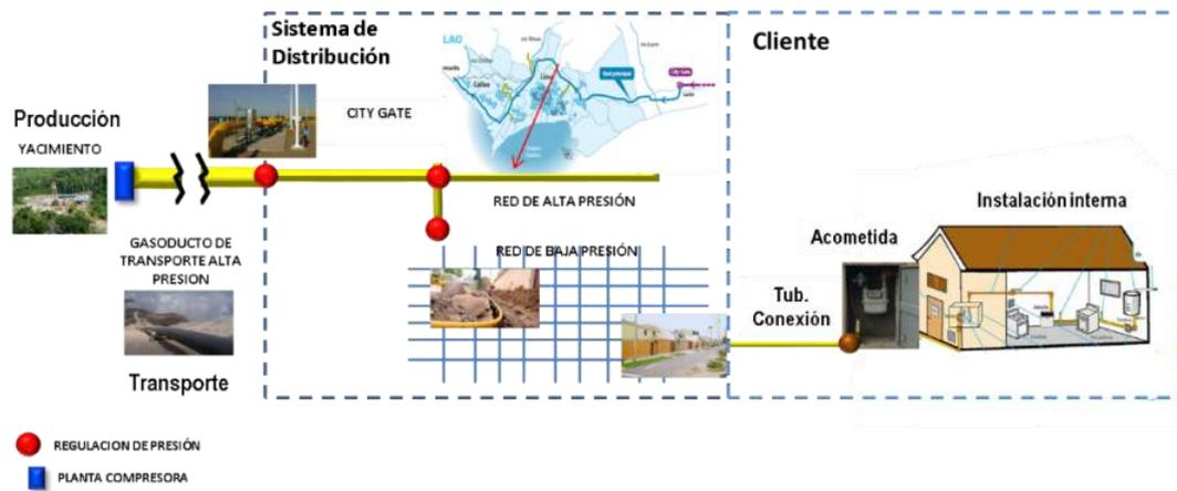
Figura 2. Estructura del suministro del gas natural.
