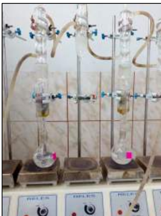
Proceso de extracción de aceites en sistema Soxhlet
