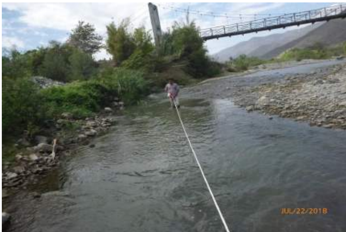
Medición de la velocidad del flotador para calcular el caudal del río Quiroz
